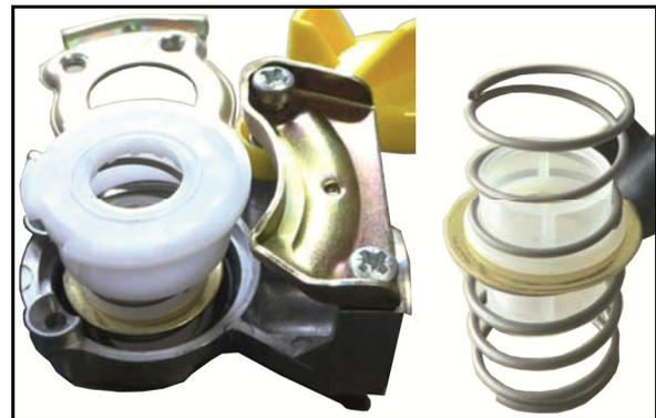
**!** Positionner correctement le joint torique sur la bague en plastique.
