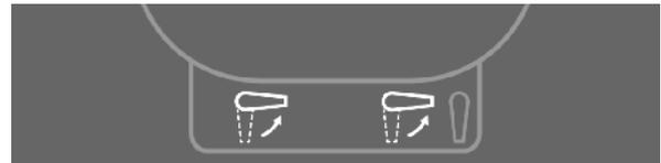
10. Colocar las llaves de conmutación en el depósito de inyección en la posición indicada.
