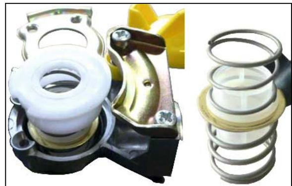
**!** O-Ring korrekt auf dem Kunststoffring positionieren.
