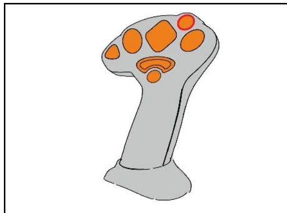
Folija sa standardnom raspodelom moguće naložiti u kabini. Za slobodnu dodelu funkcija tastera je moguće prelepliti standardni raspored.
