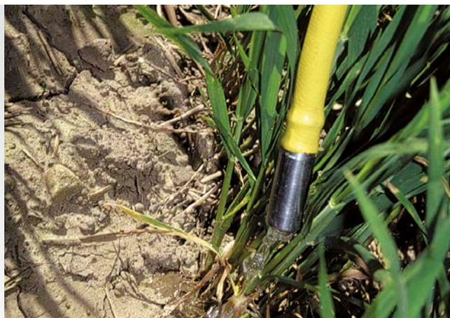
Zavorra in acciaio inox nel tubo a strascico
