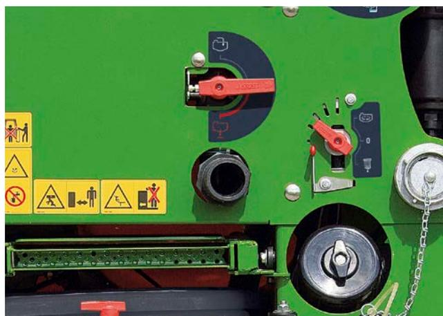
✔ È inoltre possibile disporre di un attacco di mandata per lo svuotamento rapido, tramite un raccordo da 2" (opzione).
