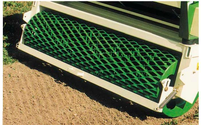
Il rullo, a griglia o liscio, comprime la semente, sostenendo la seminatrice. Il rullo a griglia viene utilizzato in prevalenza nelle seminatrici combinate, poiché lascia dietro di sé una struttura del terreno prevenendo l'infangamento e l'erosione. Il rullo liscio, può anche essere riempito d'acqua, viene utilizzato in prevalenza per il ricompattamento intenso nella cura dei campi in terra battuta.
