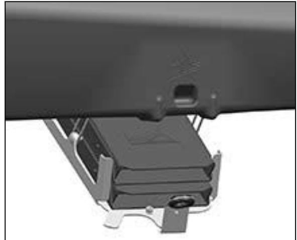
Amener les cales repliables devant les roues en actionnant le bouton-poussoir et les poser directement sur les roues avant l'attelage.
