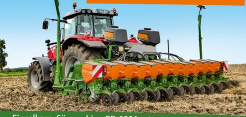
Einzelkorn-Sämaschine ED 6000 mit 12 Reihen
