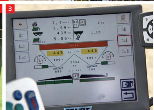
**1** Mit dem Amapad lässt sich der Streuer gut bedienen. Hier wird er zur Steuerung der Teilbreitenschaltung und des automatischen Ein- und Ausschaltens sowie zur Dokumentation benutzt.
