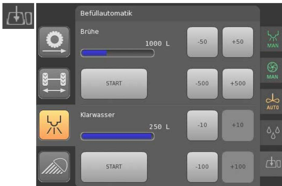
La cuve à bouillie et la cuve de rinçage peuvent être remplies en même temps et séparément par un tuyau d'aspiration.
