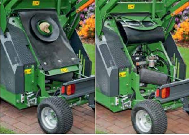
⊕ “发动机的密封性和隔尘性极佳，位于可向上折叠的橡胶活板下面。”
