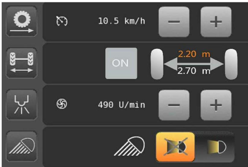
Sottomenu telaio con display e regolazione della carreggiata.
