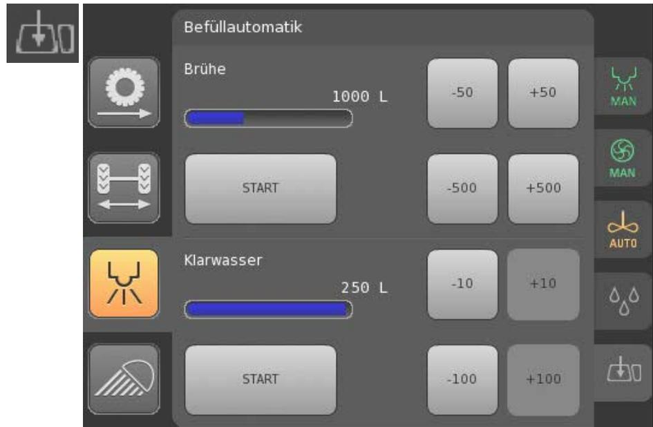
Spritzbrühebehälter und Spülwasserbehälter können gleichzeitig und separat über den Saugschlauch befüllt werden.
