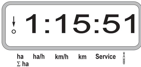
Lorsque le tracteur s'arrête de tourner et que le calculateur de ce fait n'est plus alimenté en courant, le décompte du temps s'arrête. Lorsque le tracteur démarre à nouveau la pendule se remet automatiquement en marche.
