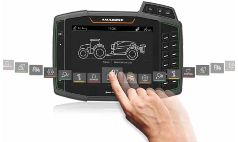
Visualización automática de los botones en el borde derecho de la pantalla mediante el sensor de proximidad
