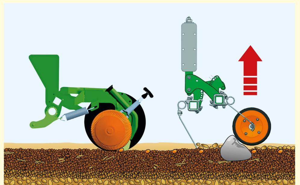
Beim Auftreffen auf einen Stein wird das RoTeC-Control-Schar nur einmal ausgehoben. Bei einem Schar mit einer Parallelogrammaufhängung mit unbeweglich am Schar befestigter Rolle zweimal.
