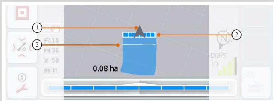
La flèche (1) indique la position du point de référence du tracteur (position de l'antenne).
