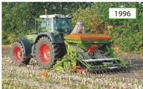
Pneumatische Sämaschine AD-P Profi mit großem Saattank.
