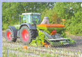
Die Cirrus Active mit großem Saatgutvorrat, integriertem Kreiselgrubber und RoTeC-Scheibenscharen ist eine schlagkräftige Großflächenmaschine.
