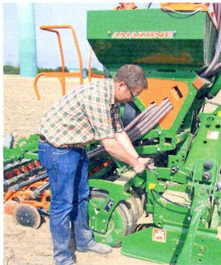
Kreiselgrubber und Planierschiene werden mittels Steckkulisze bzw. Ratsche in der Höhe verstellt.
