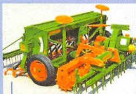
Bei der auf dem seit 1979 verfügbaren Kreiselgrubber aufgebauten AD wurde das Saatbett durch den Reifenpacker vorverdichtet.
