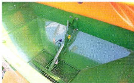
Serienmäßig fasst der leicht zu reinigende Saatgutbehälter 1.250 l. Optional sind mit Aufsatz 1.500 l drin.
