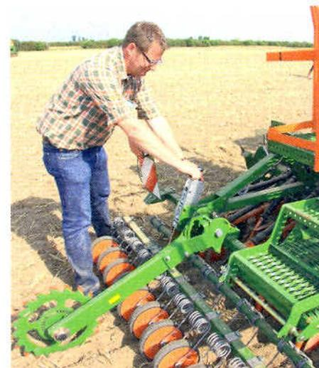
Mit zwei Stellspindeln lässt sich der Anpressdruck des Striegel komfortabel den Einsatzbedingungen anpassen.
