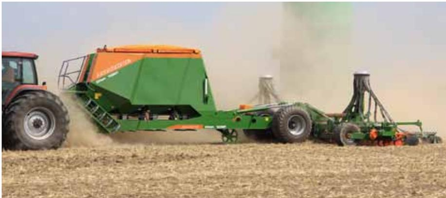
Acht, neun oder zwölf Meter breit säen auf Flächen, die mit der Grundbodenbearbeitung bereits säferti g sind, ist mit der Solo-Großflächensämaschine Citan möglich.
