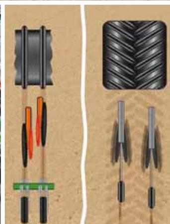
Die gezogene Cirrus folgt dem Trend zu vielseitig einsetzbaren Säkombinationen. Der große Saatguttank ist weit vorn platziert, um die Zugkraftübertragung zu verbessern. Eine Kurzscheibenegge sorgt für die Bodenbearbeitung. Keilringreifen verdichten den Boden exakt in der Rille für das Scheibenschar RoTeC+. Der Rollenstriegel drückt den Boden an und verteilt fein gekrümelte Erde über der Saat.
