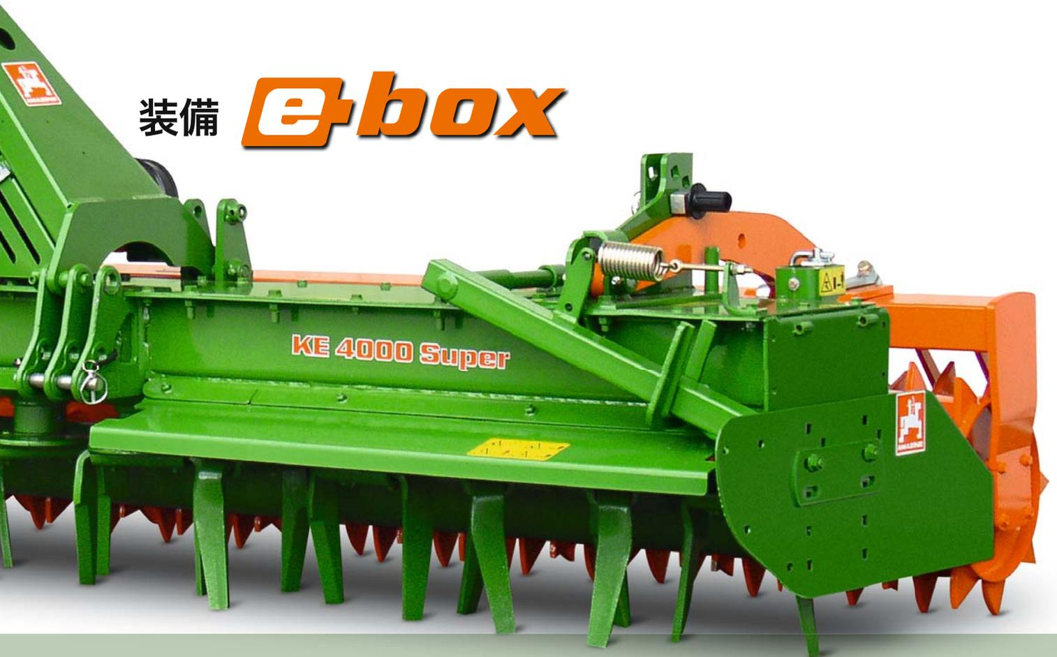
サイドプレートは弾性があり、石に当たれば上方へ逃げます。連結フレームが長く、安定したスプリングを持つ KE Super (スーパー)は石の多い土質の重い土地でも使用することができます。
