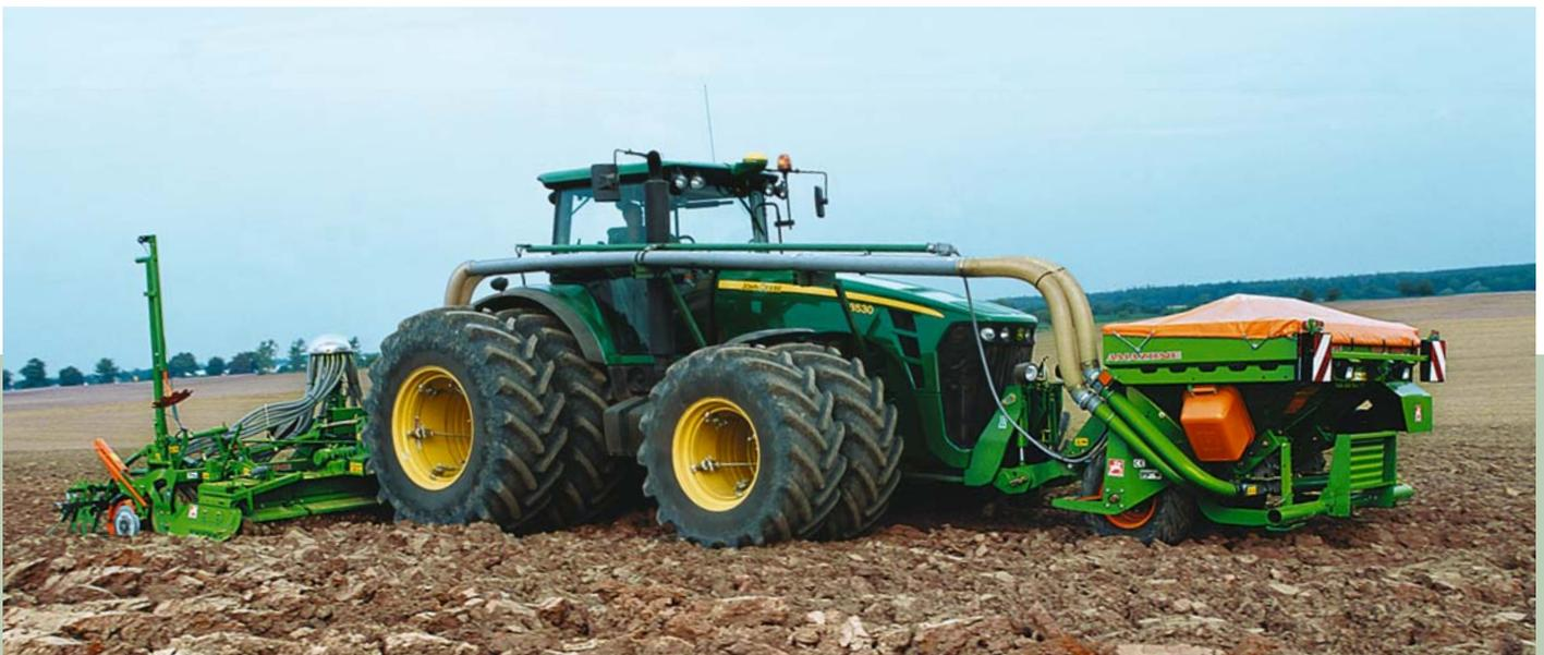
コンビネーションシーダ Avant(アバント)はフロントタンクと折り畳み式ロータリーカルチベータから構成されます。フロントタンク型コンビネーションシーダ Avant(アバント)は、大面積の播種作業を効率的に行おうとする作業請負業者や大規模農家にとって非常にフレキシブルな万能コンビネーションの機械です。
