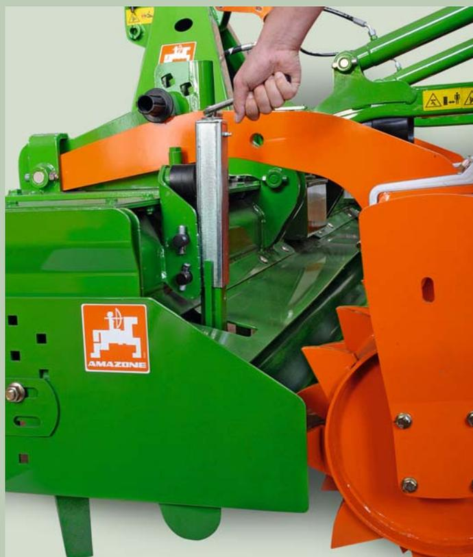
レベリングバーはパワーハローとローラーの間で土の流れを均平にし、石を下方へ押し下げます。レベリングバーの高さはクランクにより快適かつ迅速に調整可能で、後に続くローラーにより鎮圧が均一に行われる前提条件を確保します。
