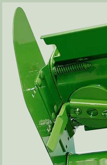
フレキシブルなサイドプレートによって、外側のタイヤにより土が土手状に積み上げられてしまうのを防ぐことができます。標準装備のサイドプレートは弾性を保って支持されているので、石との衝突を回避することができます。
