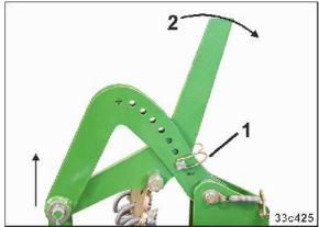
3. Переведите рычаг регулировки (Рис. 185/2) вперед, чтобы собачка (Рис. 186/1) зафиксировалась
