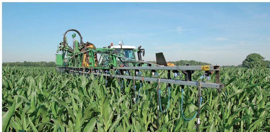
Insgesamt beziffert Holters die Kosten für die Ausrüstung seines 21-Meter-Gestänges mit 28 Droplegs im 75 cm Reihenabstand auf knapp 3500 Euro.
