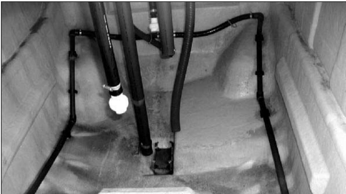
Fig. 36 Rührwerk und Behälterwaschdüsen im Brühebehälter
