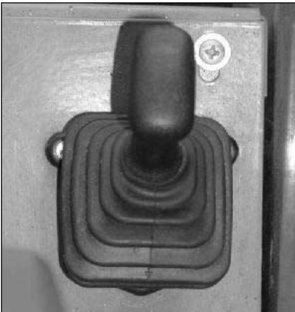
Fig. 5 Feststellbremse
