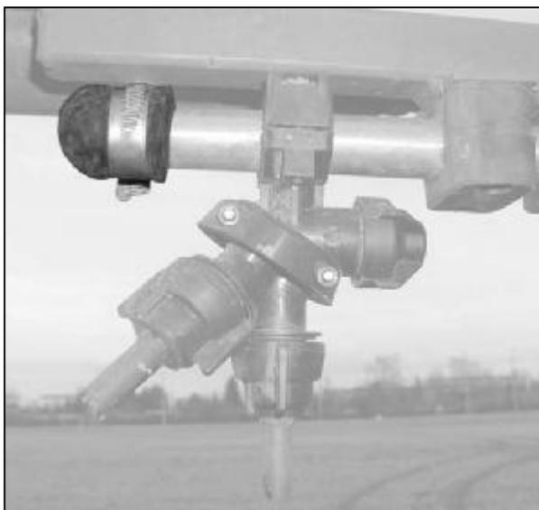
Fig. 100 Endverschlusskappe
