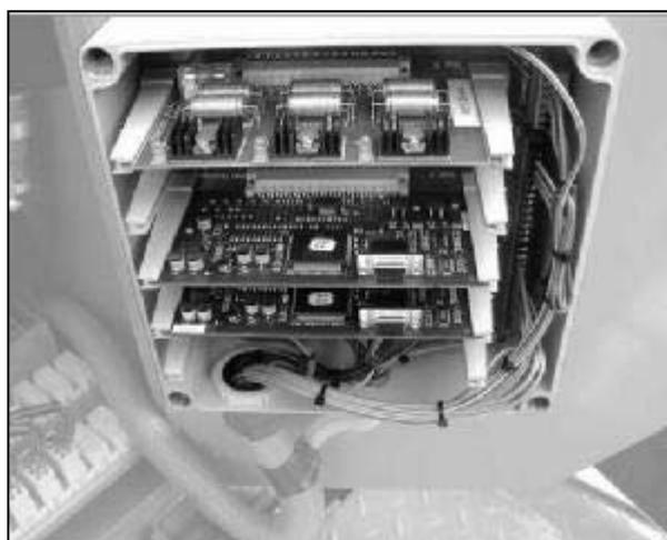
**Fig. 31 Schaltkasten Lenkung und PWM-Regelung**
