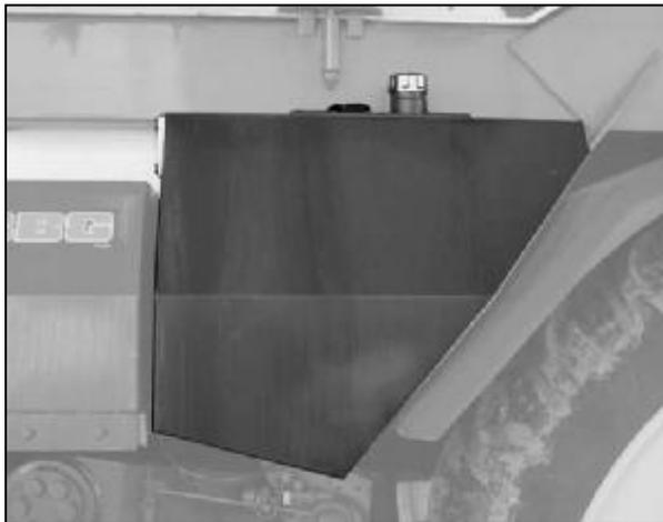
In Behälter ist ein elektrischer Sensor (5) integriert, der bei Absinken des Ölstandes unter den Minimalpegel ein Signal in die Kabine gibt. Über Sensor (3) gibt es ebenfalls ein Signal, wenn die Temperatur des Hydrauliköls über normal ansteigt.
