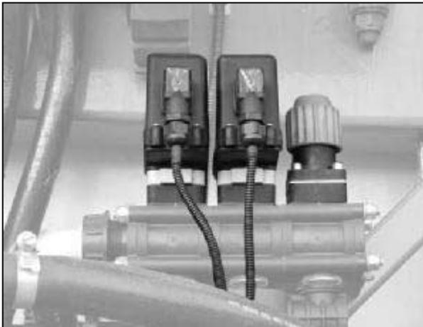
**Fig. 94 Elektrischer Druckregler**
