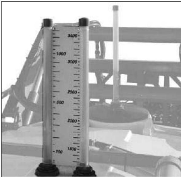
Fig. 38 Füllstandsanzeige Brühebehälter
