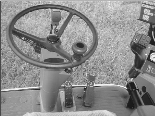
Fig. 4 Kabinenboden mit Brems- und Fahrpedal
