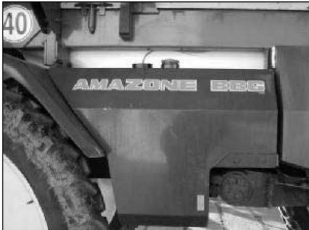
Fig. 13 Kraftstoffbehälter
