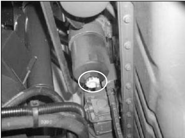
Fig. 69 Ablasshahn am Kraftstoffvorfilter
