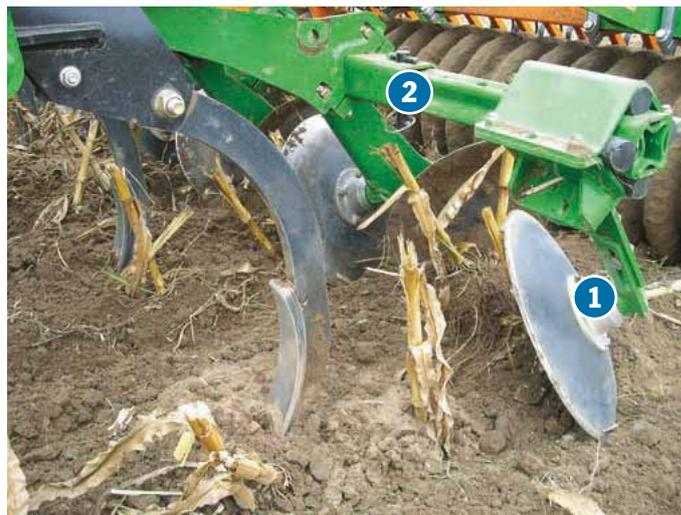
Die Randscheiben lassen sich mit Werkzeug in der Höhe verstellen (1). Zur Anpassung an verschiedene Schare sind sie ausziehbar (2).
