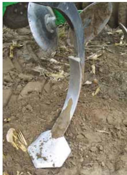
Stoppeln gelockert. Hinsichtlich der Einarbeitung der Maisstoppeln und gab es keinen Grund zur Kritik. Selbst an extrem verunkrauteten Stellen passte das Arbeitsbild. Dabei setzte sich der Grubber nie zu. Allerdings gilt auch beim Cenius: Damit Schare und Nivellierscheiben optimal mischen, sollte nicht langsamer als 10 km/h gefahren werden.
