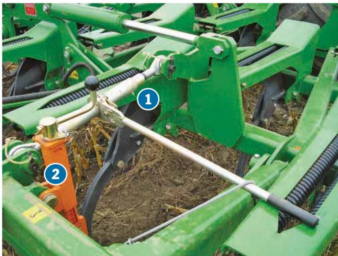
Die Arbeitstiefe wird wie beim Centaur mit Stellspindeln (1) eingestellt. Mittels Kurbeln (2) werden die Scheiben nachjustiert.
