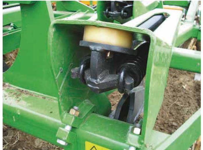
Zwei liegende Spiralfedern dienen als Überlastschutz. Durch Änderungen am Träger schlagen sie nun nicht mehr an der Oberseite an.
