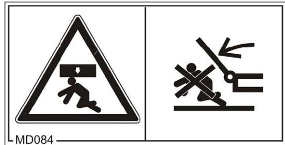
**MD089****Risques d'écrasement de différentes parties du corps en cas de stationnement sous des charges suspendues ou sous des éléments relevés de la machine !**
