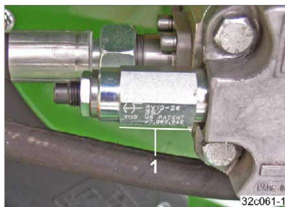
Limiteur de pression avec contour extérieur six pans (1)
