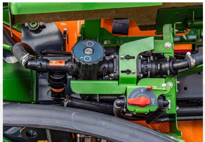
✔ HighFlow<sup>+</sup> est équipé d'un filtre pression supplémentaire autonettoyant
