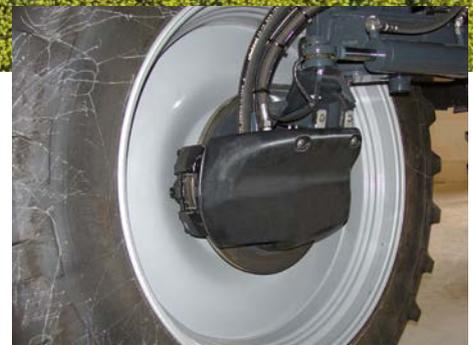
✔ Cache moteur de roue en standard sur le Pantera 4504
