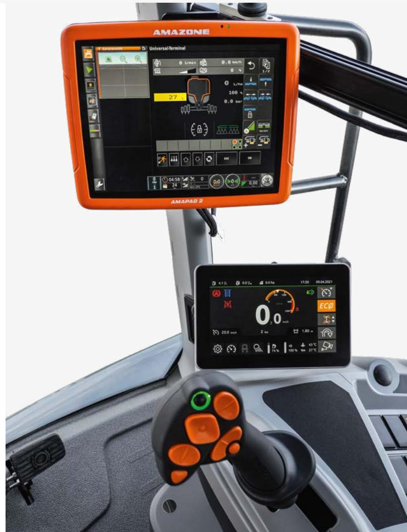
Solution deux terminaux avec terminal ISOBUS AmaPad 2, terminal véhicule AmaDrive 7.0 et poignée multifonction AmaPilot+
