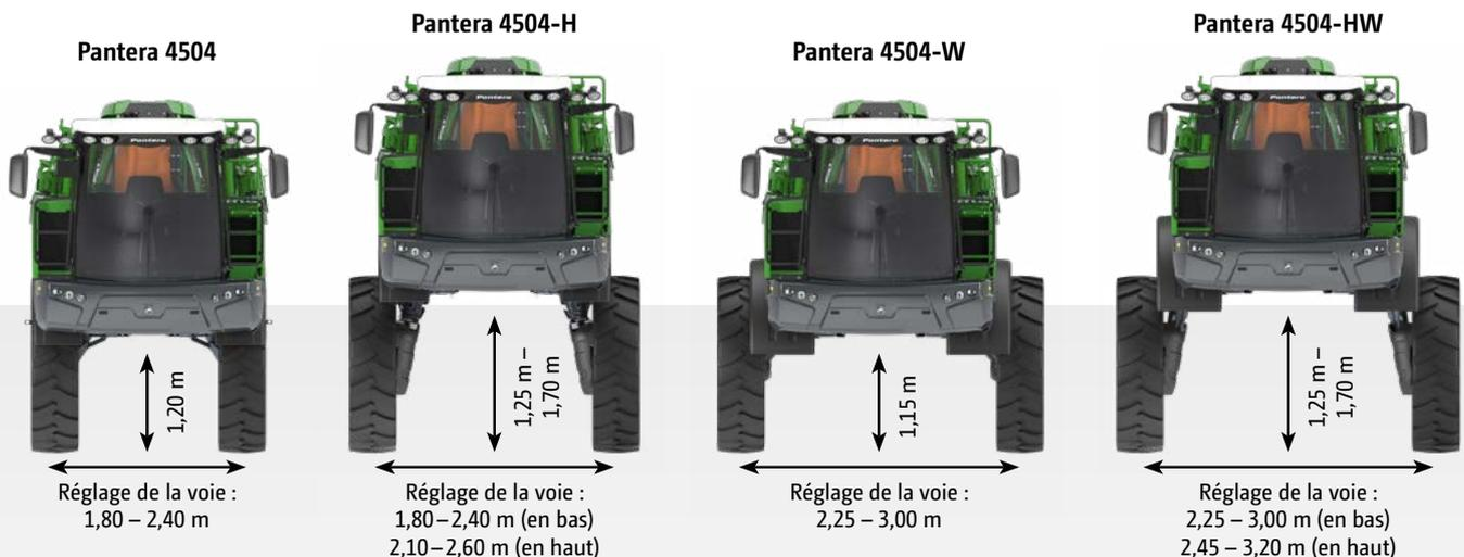
Voie et garde au sol respectivement avec pneus 380/90 R50 (déport de roue + 50 mm)
