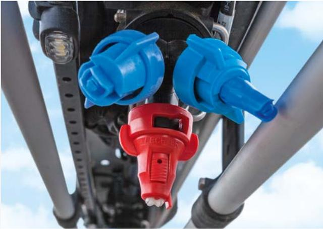
✔ Coupure électrique buse à buse AmaSwitch
