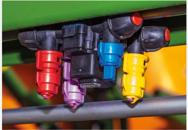
✔ Coupure électrique buse à buse AmaSelect
