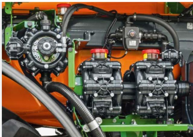
La pompe eau claire (160 l/min) est logée à côté de deux puissantes pompes à piston membrane (520 l/min)
