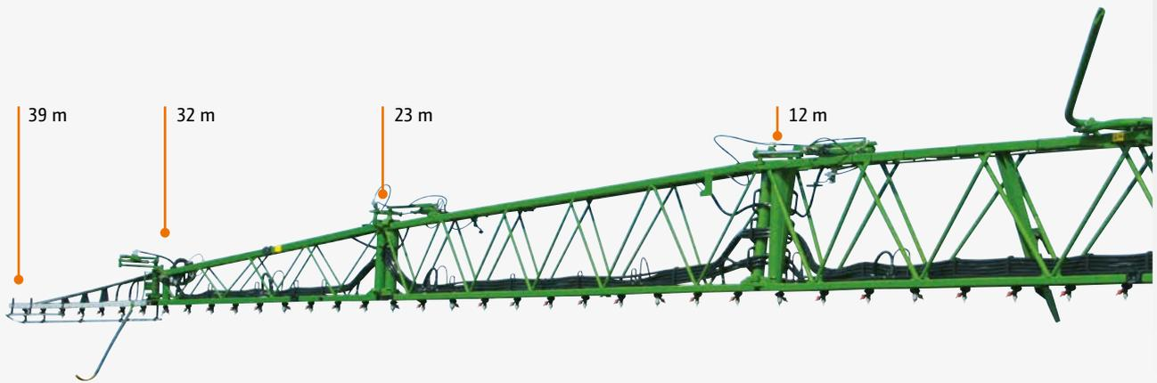
Rampe Super-L2 39 m pouvant être réduite à 32 m, 23 m et 12 m
