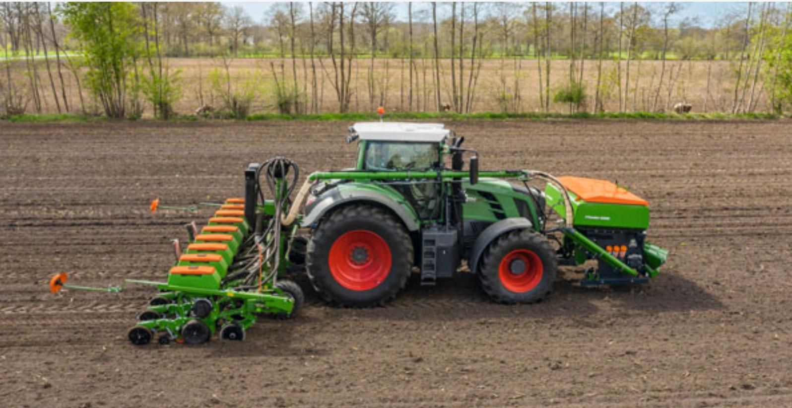
Frontanbaubehälter FTender 2200 mit Einzelkorn-Sämaschine Precea 6000-2FCC
