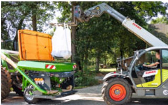
Große Behälteröffnung von 1,1 m x 2,2 m zur schnellen und einfachen Befüllung des FTender
