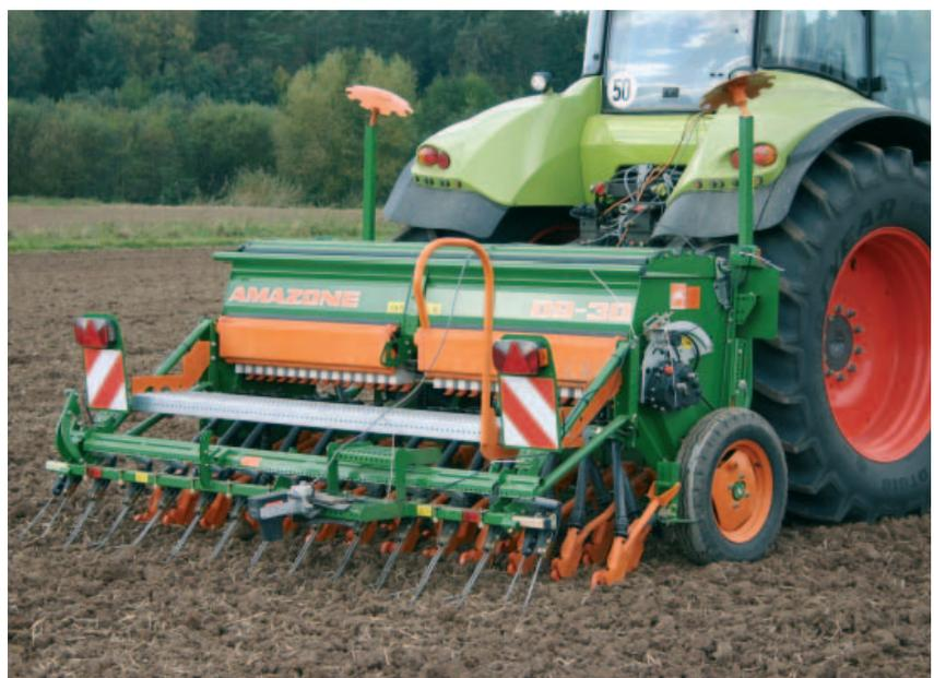
Die 3-Meter-Anbau-Sämaschine musste zeigen, ob die eingestellten Saatmengen auch eingehalten wurden und wie gleichmäßig die Querverteilung ist.
