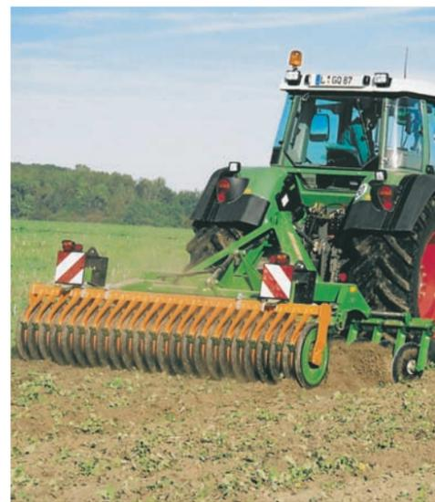
«Catros 6000» отличают возможность регулировки без применения инструментов и не требующие технического обслуживания опорные узлы с контактным уплотнителем, наличие резиновых защитных элементов при наезде на камни. В связи с этим нет
