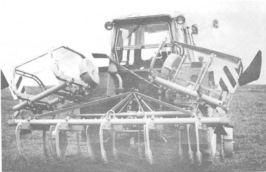
Bild Nr. 2 Anbau-Grubber B 245 in Transportstellung
