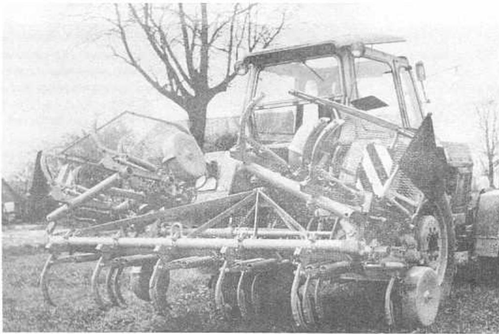
Bild Nr. 3 Anbau-Grubber B 255 in Transportstellung
