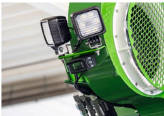
Подсветка системы сошников с системой камер обеспечивает хороший обзор даже в темноте и при движении в ночное время
