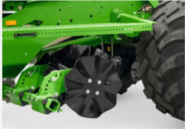
Механическая регулировка по высоте следорыхлителя с рифленным диском
