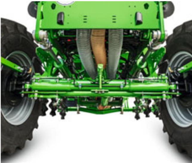
Гидравлические цилиндры телескопической оси
