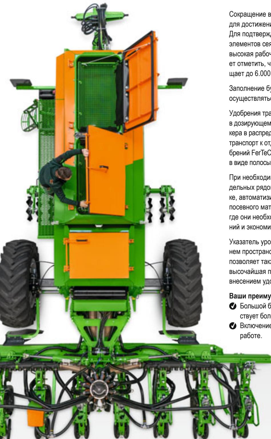
Сокращение времени заполнения имеет важное значение для достижения высокой урожайности при точном высеве. Для подтверждения действенности других конструктивных элементов сеялки Precea-TCC (большая ширина захвата, высокая рабочая скорость, большой семенной бункер) следует отметить, что двухсекционный бункер для удобрений вмещает до 6.000 л гранулированных удобрений.
