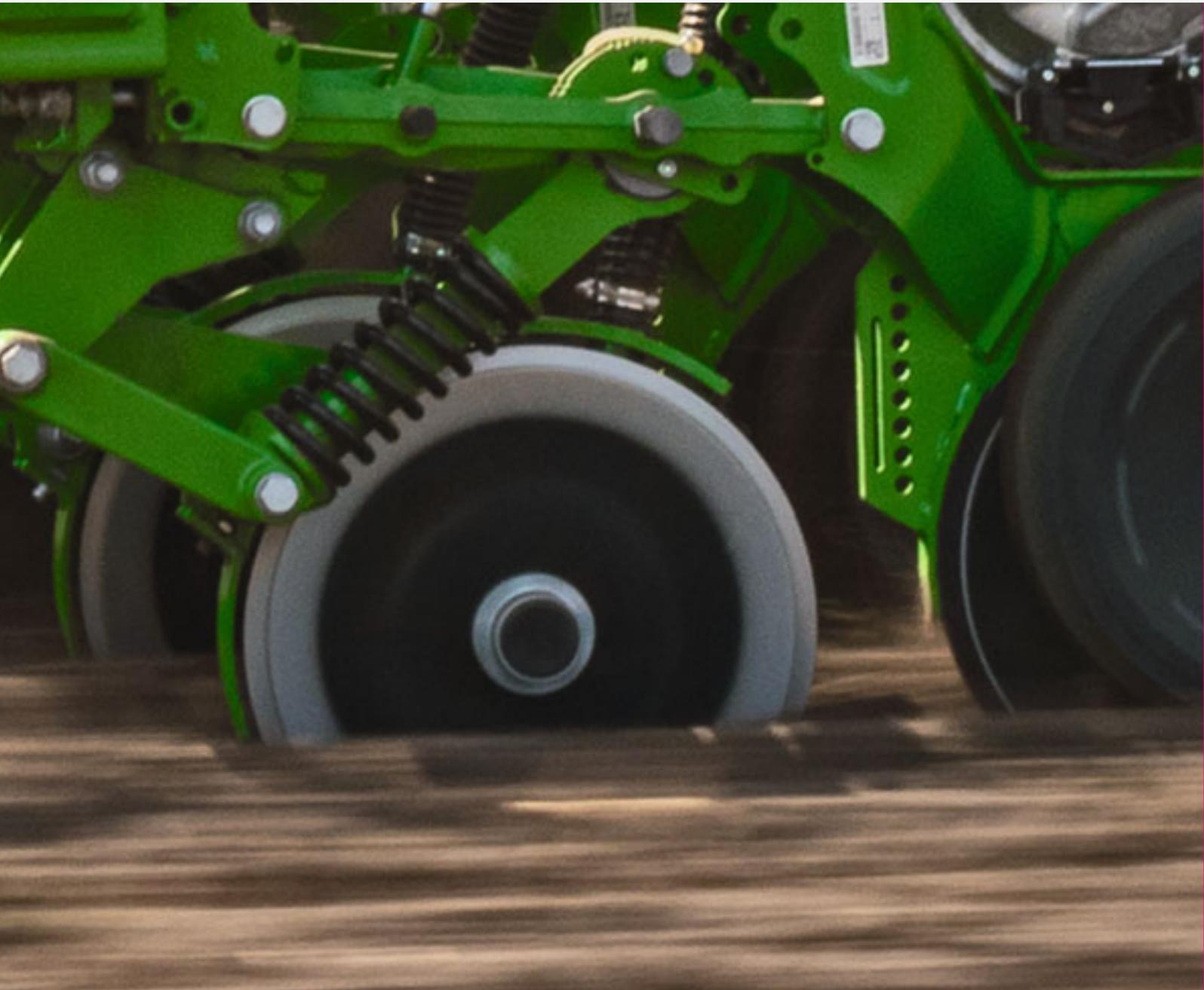
Высокопроизводительный двухдисковый HD-сошник для удобрений FerTeC twin подходит для традиционного и мульчированного посева.
