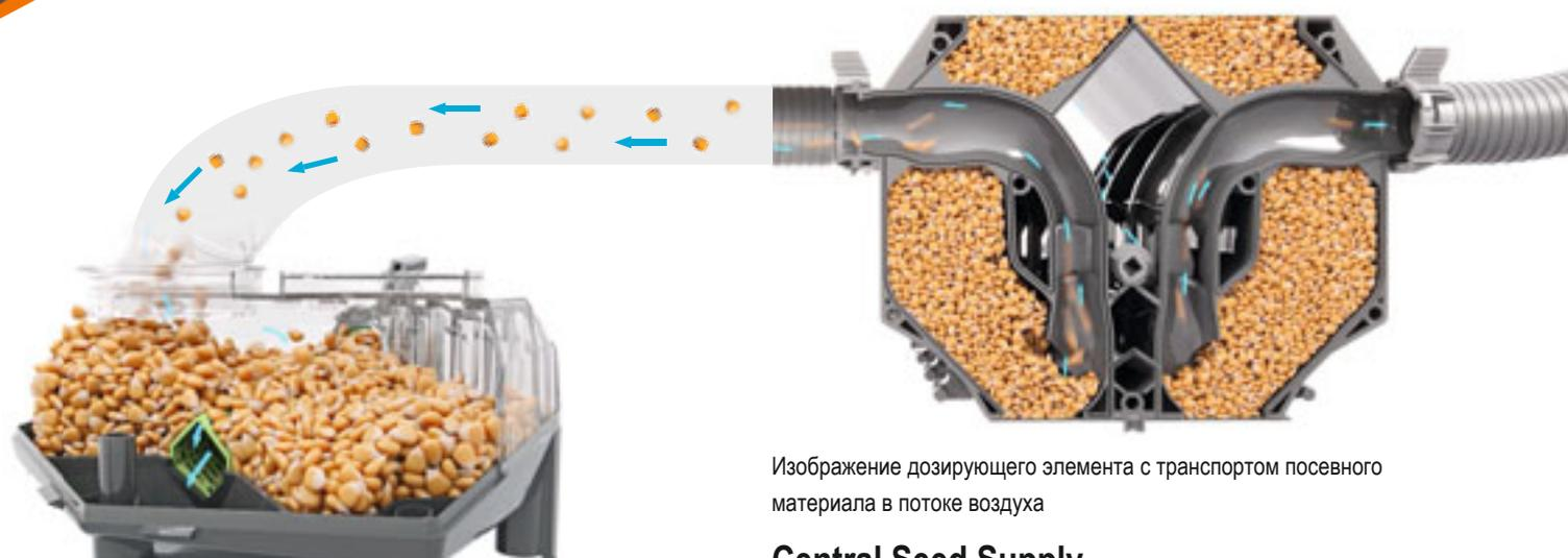
Изображение дозирующего элемента с транспортом посевного материала в потоке воздуха
