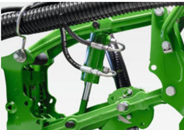
С помощью цилиндра можно гидравлически установить давление на сошник.
