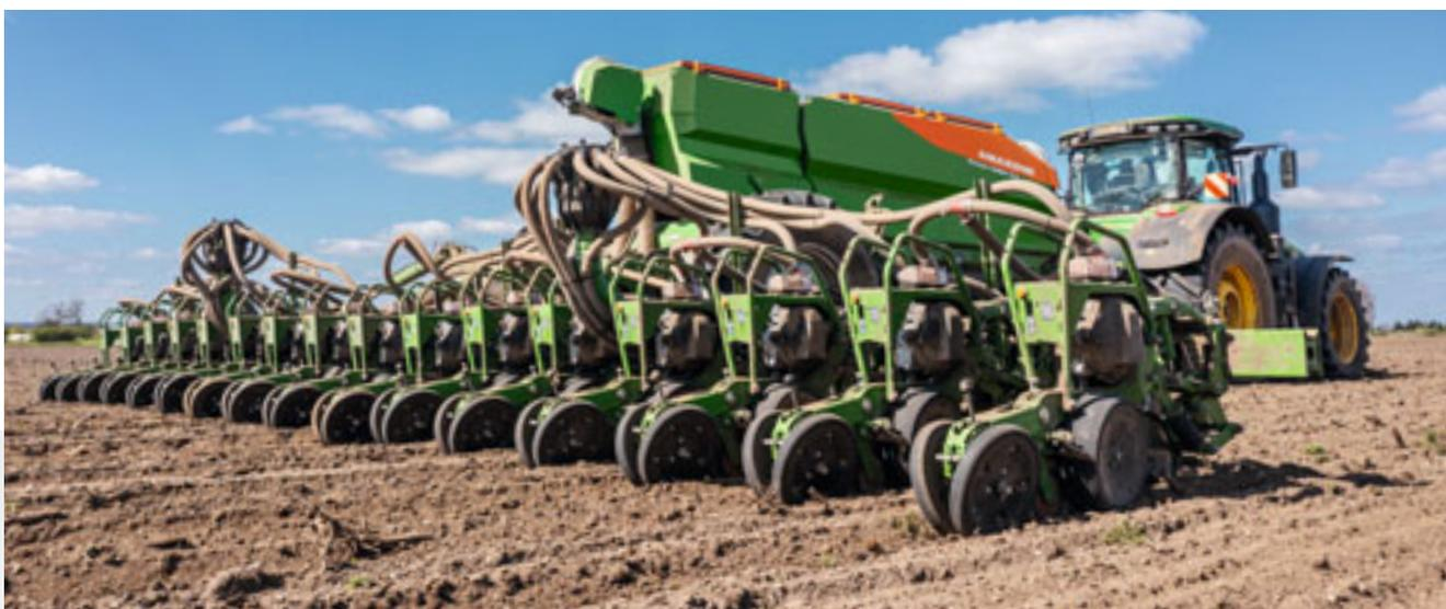
Равномерное продольное распределение удобрений также при большой ширине захвата за счет двух распределительных головок.
