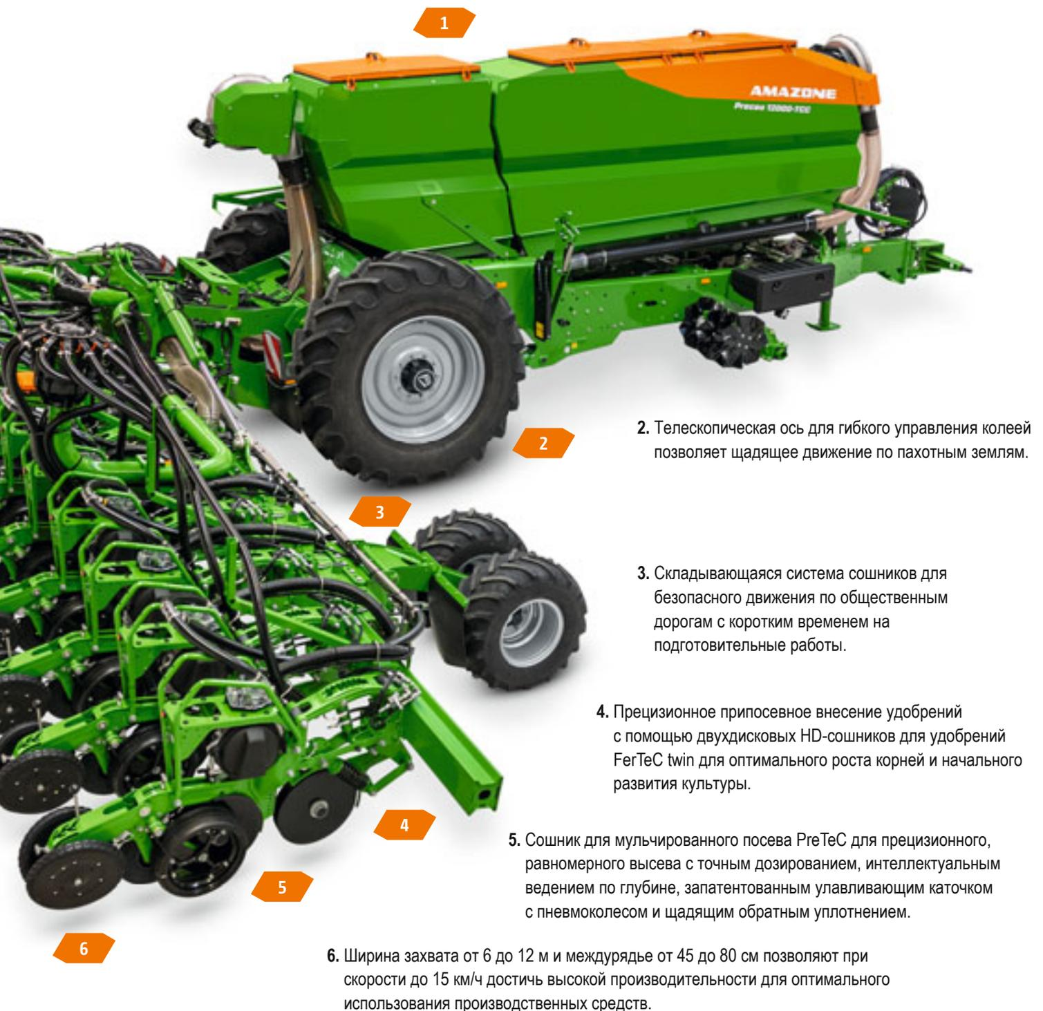
2. Телескопическая ось для гибкого управления колеей позволяет щадящее движение по пахотным землям.
