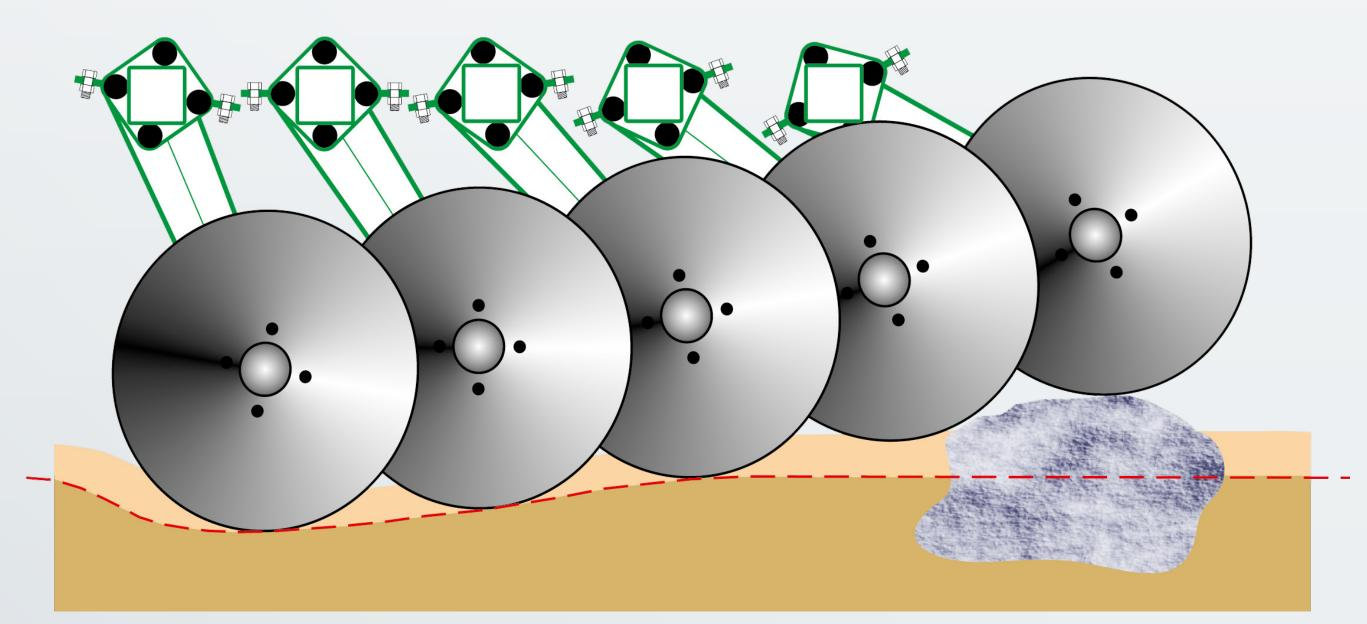
Die **elastischen Gummifederelemente** an jeder Scheibenaufhängung dienen nicht nur der optimalen Anpassung an die Kontur der Bodenoberfläche, sondern auch als Überlastsicherung für die einzelnen Scheiben. Die großdimensionierten Gummifedern sind wartungsfrei.
