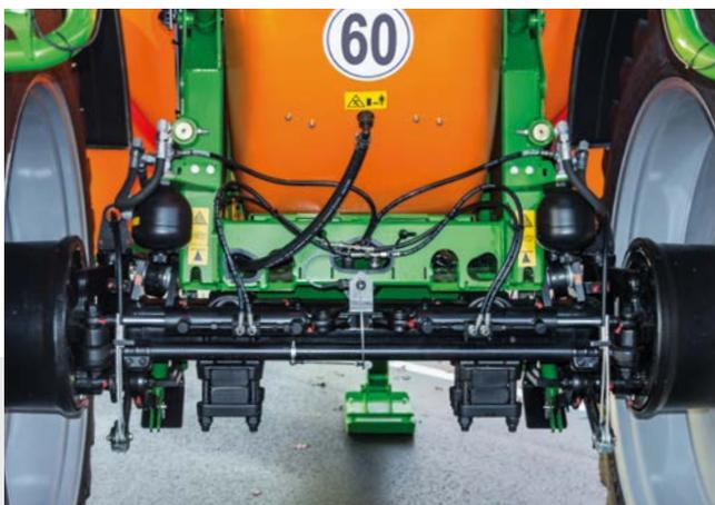
Amortiguación hidroneumática de los ejes con extremo articulado del eje para los modelos UX 4201 y UX 5201
