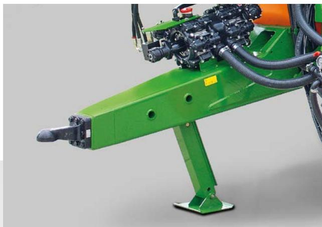
Suspensión inferior con enganche esférico de tracción K80 y pie de apoyo hidráulico
