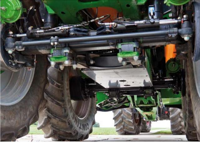
El tren de rodaje hidroneumático del UX 11201 Super permite un perfecto confort de marcha y garantiza el máximo rendimiento por superficie
