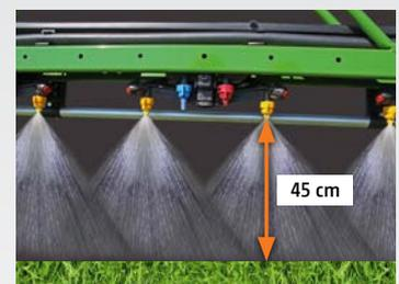
Boquillas 80°: Distancia entre boquillas 25 cm
