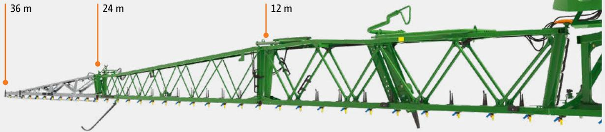
Barra Super-L3 con un ancho de trabajo de 36 m, con posibilidad de reducción a 24 m y 12 m
