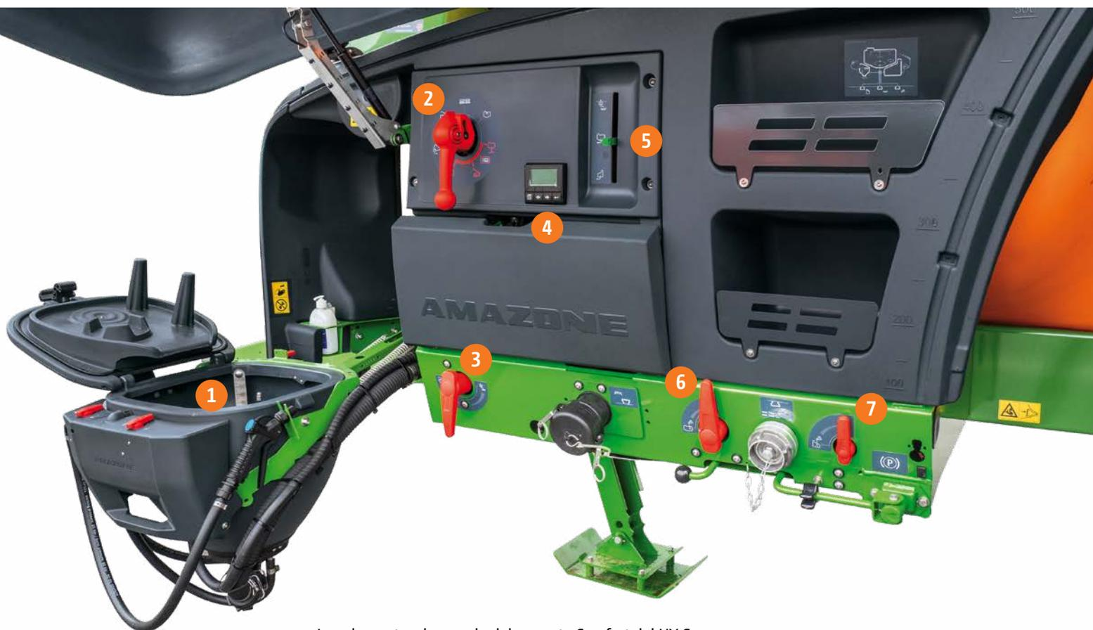
Los elementos de mando del paquete Confort del UX Super
