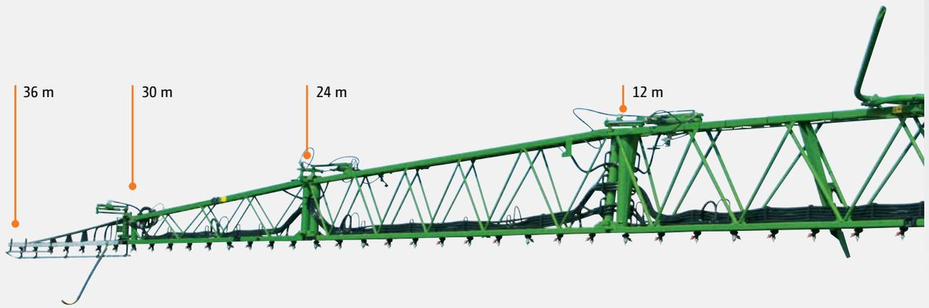
Barra Super-L2 con un ancho de trabajo de 36 m, con posibilidad de reducción a 30 m, 24 m y 12 m
