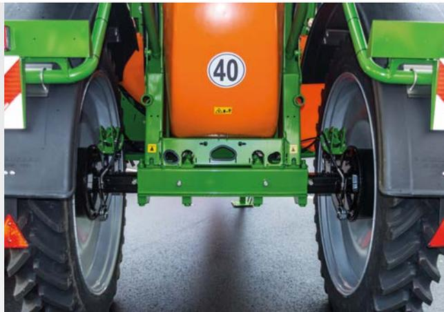
Eje regulable con ajuste continuo del ancho de vía de 1,50 m a 2,25 m para el UX 4201
