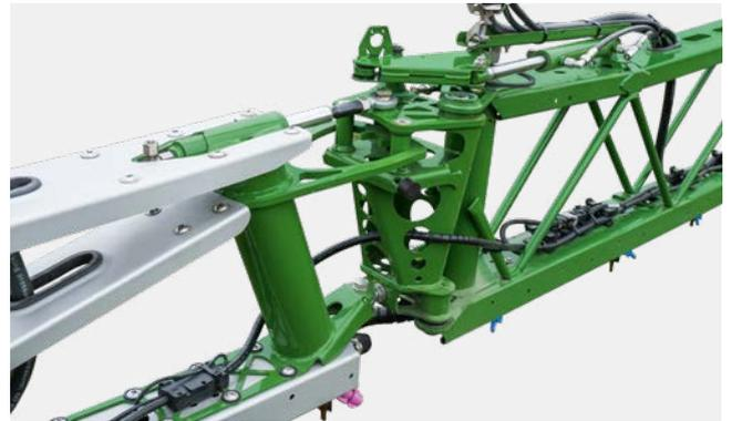
El seguro de sobrecarga pretensado hidráulicamente del pescante del extremo (con principio de funcionamiento de puerta de vaivén) se puede desviar de serie hacia atrás, hacia delante y hacia arriba y garantiza un retorno fiable y una larga vida útil.
