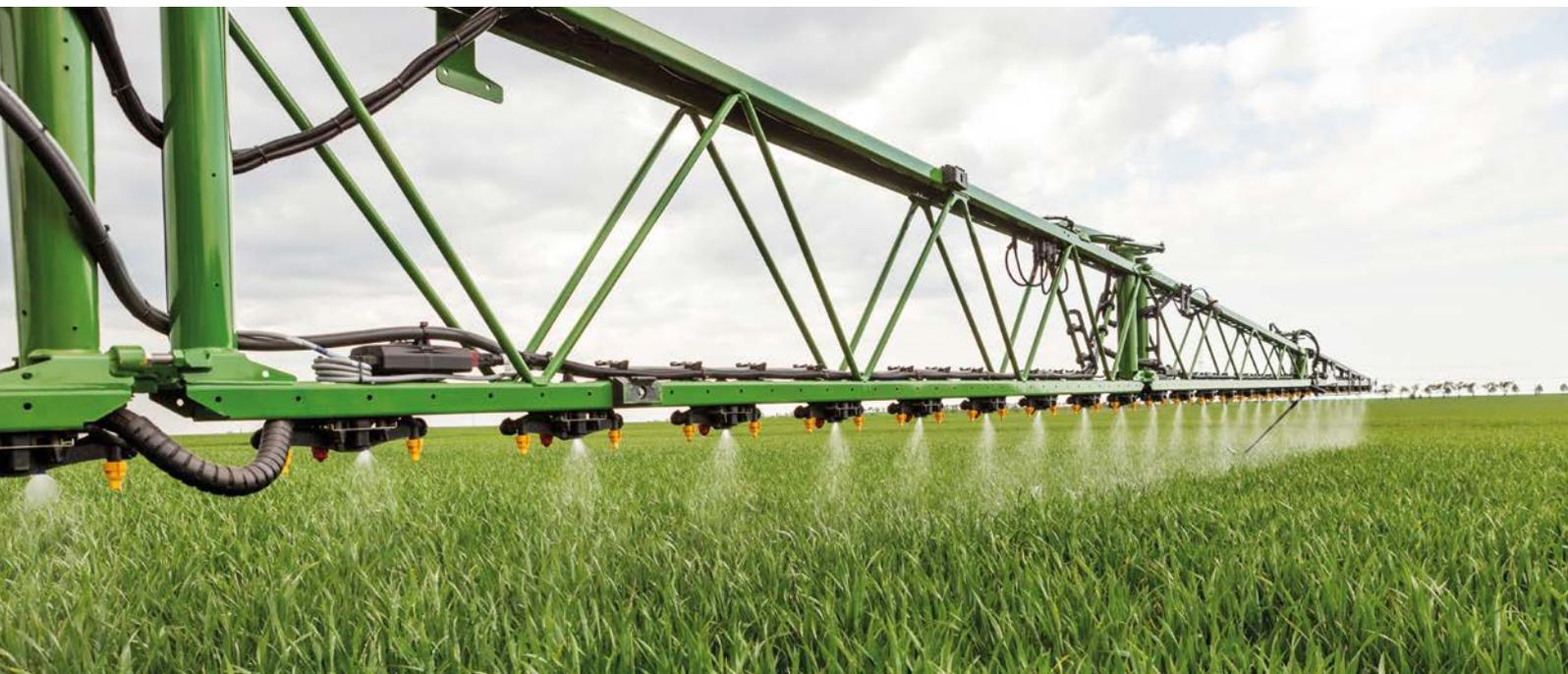
Equipamiento con mangueras de arrastre en control de boquillas individuales AmaSwitch con cuerpo de boquilla cuádruple y juego de prolongación en las barras Super-L2
