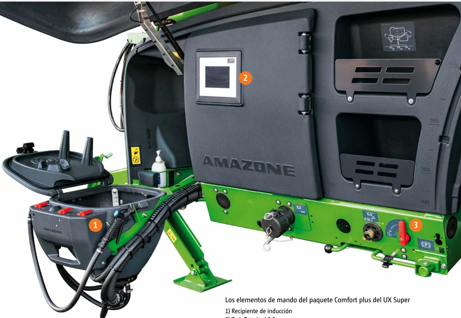
Los elementos de mando del paquete Confort plus del UX Super
