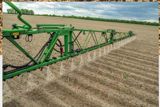
Pulverización en banda por hileras en el cultivo de remolacha azucarera
