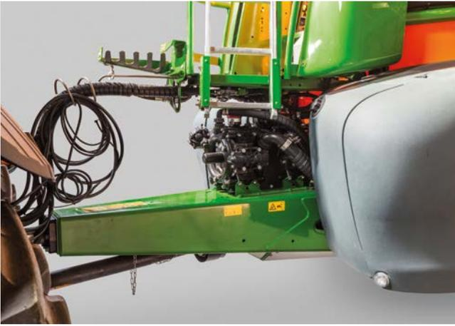
El sistema de doble bomba del UX 4201 Super, UX 5201 Super y UX 6201 Super proporciona capacidades de aspiración de hasta 700 l/min
