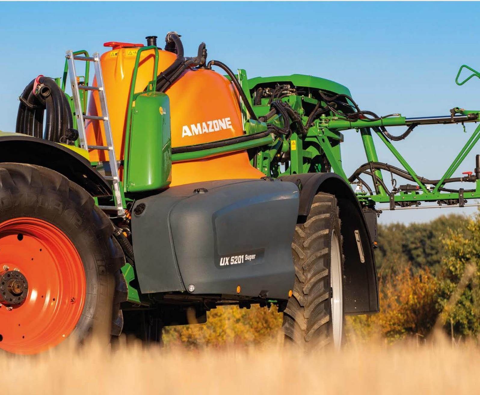
El extremo articulado del eje AutoTrail durante el uso
