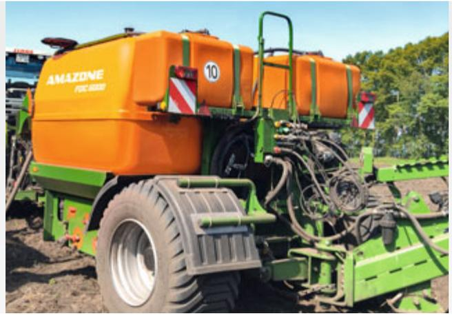
Dos depósitos de agua de lavado de 300 l
