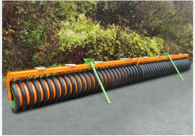
❗ «Las mordazas atornilladas permiten el desmontaje sencillo del rodillo en condiciones de suelo húmedo o para la preparación basta de surcos en otoño.»
