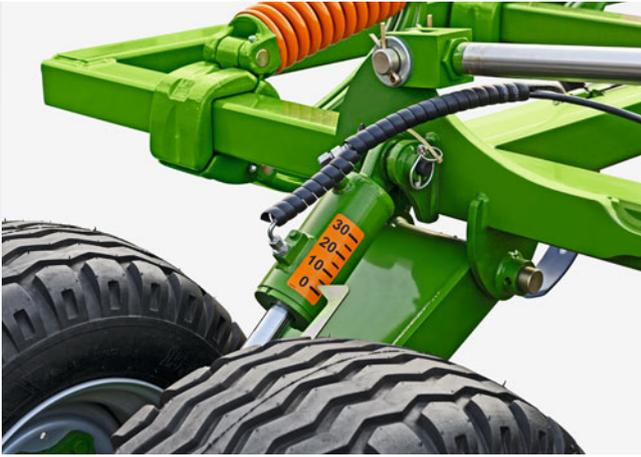
Escala del ajuste completamente hidráulico de la profundidad de trabajo del segmento de púas
