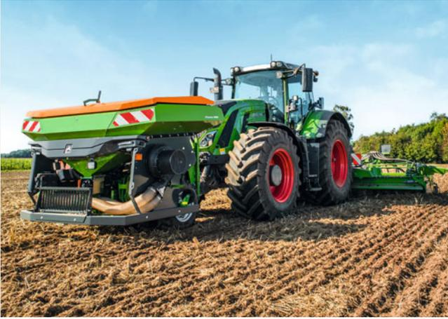
Depósito de montaje frontal FTender 1600 con una capacidad del depósito de 1.600 l
