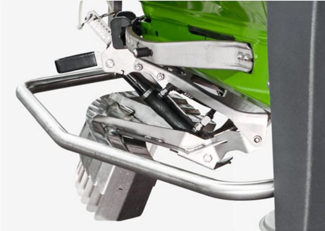
Dispositivo de dispersión en límite hidráulico Limiter V
