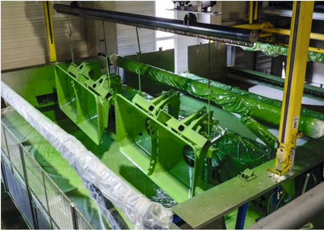
La imprimación por inmersión con carga eléctrica de todos los componentes permite una protección anticorrosión casi total de la superficie.
