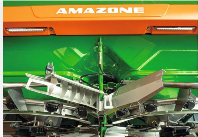
La iluminación del mecanismo esparcidor está integrada de forma segura en el soporte de la iluminación, aquí, en la ZA-TS, con panel BorderTS y ArgusTwin.
