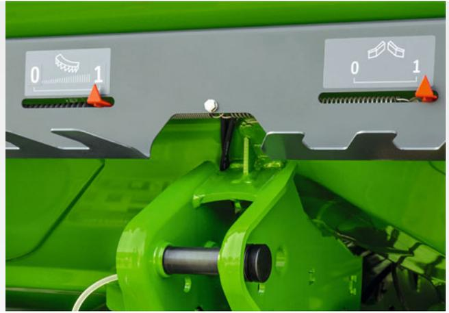
Indicación de la posición del Limiter (izquierda) y de la posición del panel de dispersión en franjas o del panel de dispersión en límite (derecha)
