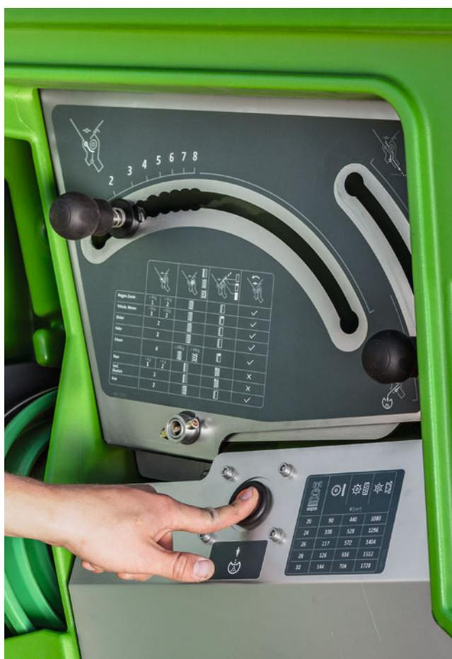
✓ En standard, ElectricDrive est équipé de la touche d'étalonnage pratique sur le SmartCenter
