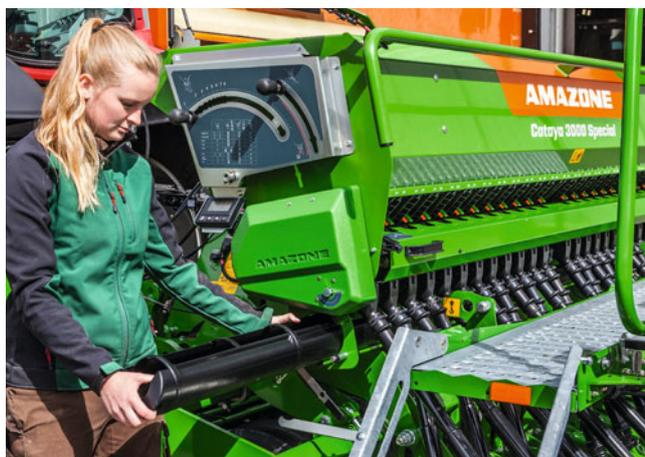
✓ Augets d'étalonnage en deux éléments
