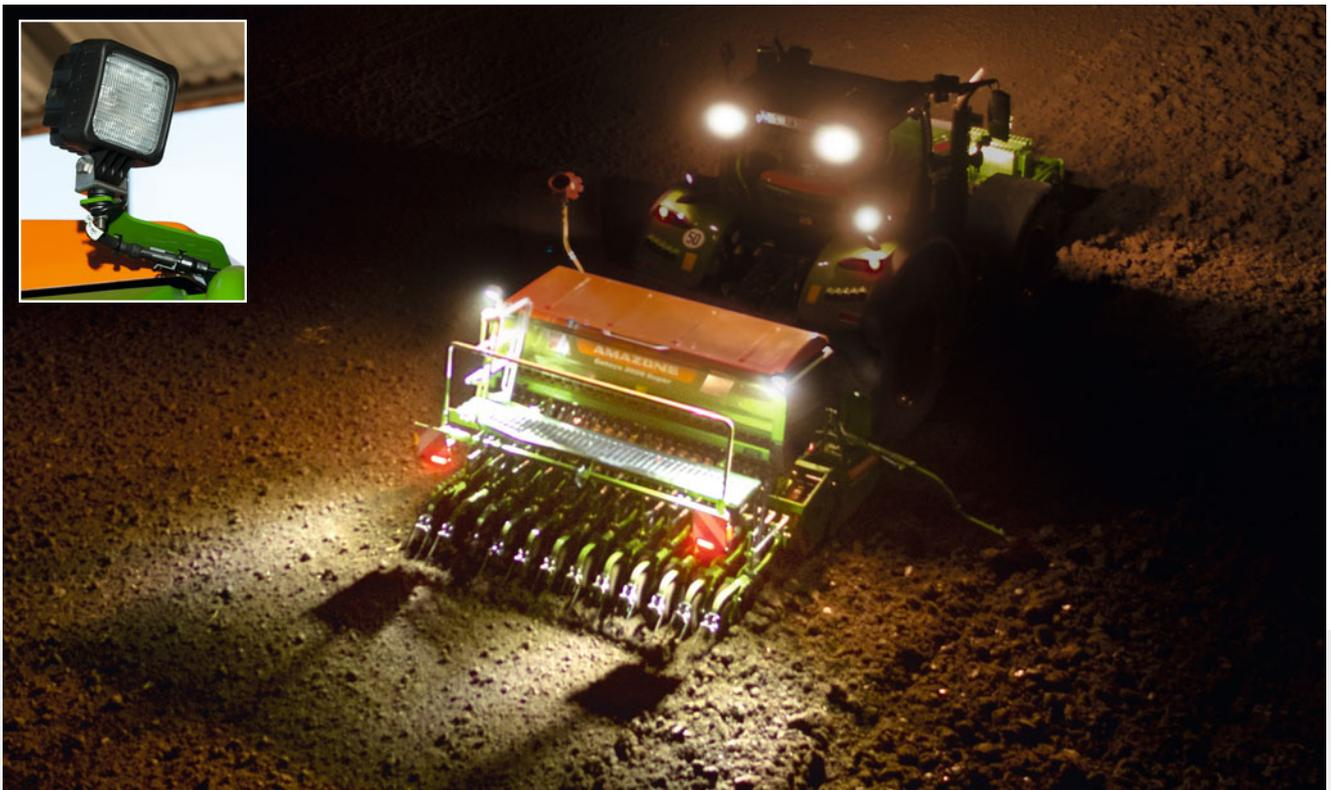
✔ Visibilité optimale de nuit grâce à un éclairage de travail à LED en option
