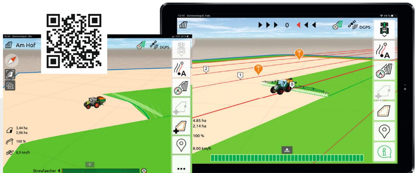
Mode d'affichage Cartes avec AmaTron Twin – Représentation claire de la machine et de ses tronçons et des boutons de commande à droite de l'écran du terminal mobile.
