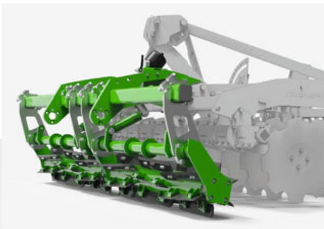
Rodillo de cuchillas delantero de 330 mm de diámetro
