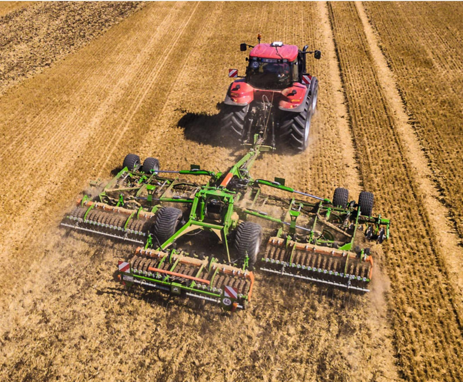
Catros<sup>+</sup> 8003-2TX con rodillos de anillo cónico con perfil de neumático Matrix en un ancho de trabajo de 8 m
