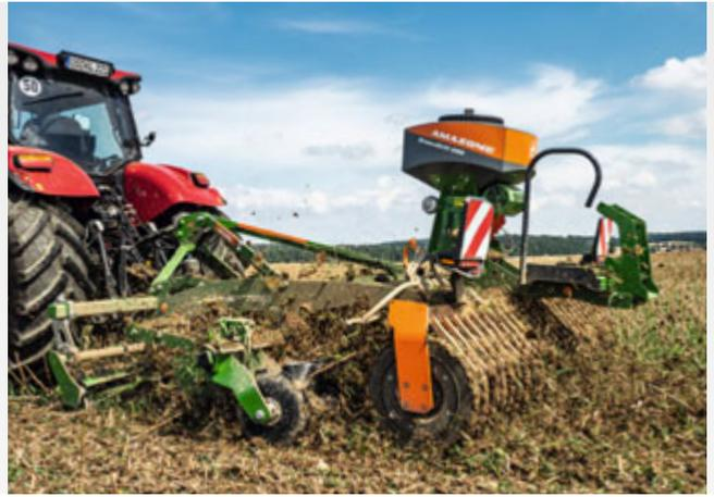
Catros<sup>XL</sup> 3003 con X Cutter Disc, rodillo de cuchillas y GreenDrill
