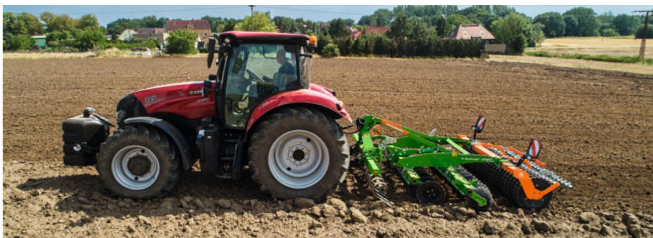
El crushboard se encarga de aplastar los terrones de tierra de gran tamaño por delante del cuerpo de discos, garantizando de esta forma un resultado de trabajo aún mejor
