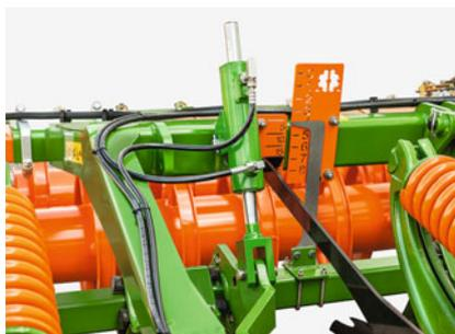
Цилиндр для регулировки выравнивающих элементов
