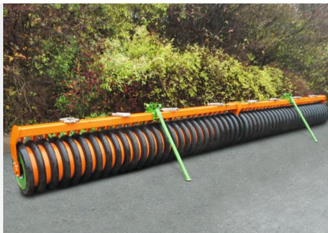
❗ «С помощью закручиваемых зажимов каток можно легко демонтировать при влажных условиях или при наличии грубой, «осенней борозды».
