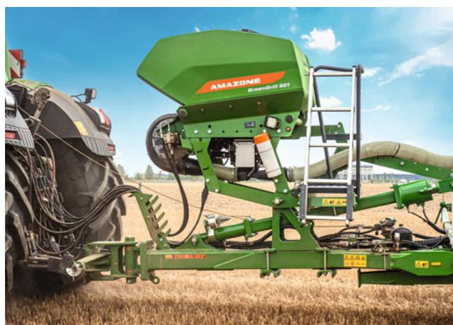
GreenDrill 501: для всех прицепных машин с объёмом бункера 500 л и гидравлической турбиной
