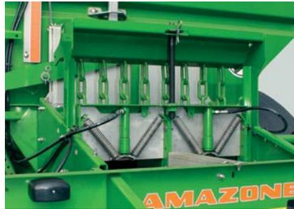
Las correderas hidráulicas permiten la desconexión unilateral, por ejemplo, para la fertilización básica. Para la aplicación de cal ligeramente húmeda, estiércol de gallina seco, lodos de depuradora secos, etc., basta con subir la corredera con la manivela y bajar el rastrillo de cadenas si es necesario.
