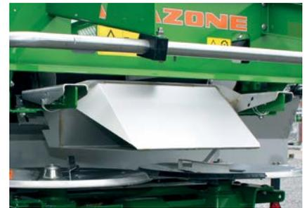
Robusta rampa de la tolva: para la aplicación de fertilizante granulado en combinación con discos esparcidores OM (ZG-B Special, ZG-B Super, ZG-B Drive).
