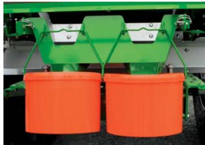
El dispositivo de calibración permite comprobar la velocidad de paso del abono. Puede determinar exactamente la dosis de aplicación.
