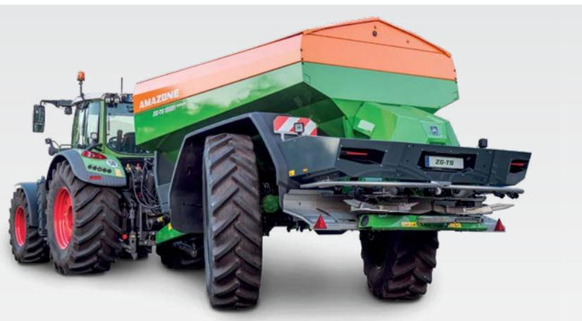
Eje de dirección con hasta 28° de ángulo de giro
