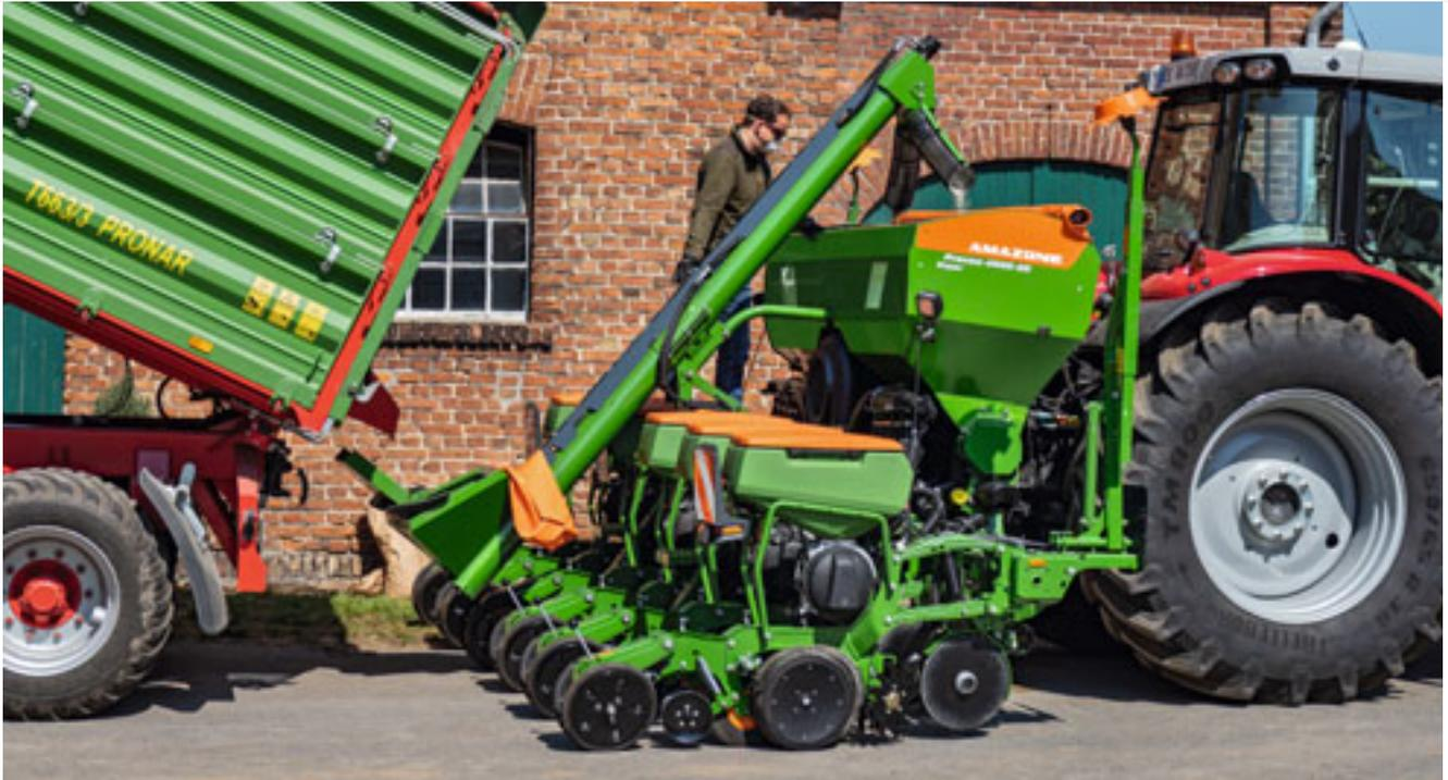
Die optionale Befüllschnecke bietet ein bequemes Befüllen des Düngerbehälters
