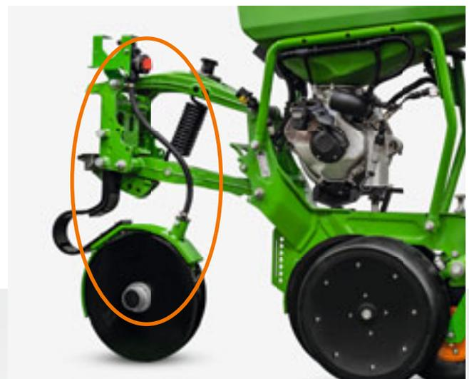
Flüssigdünger-Set am FerTeC Twin-Düngerschar
