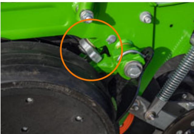
Bei wechselnden Böden registriert der Messbolzen Veränderungen in der Aufstandskraft. Das ISOBUS gesteuerte SmartForce-System regelt diese Schwankungen dann automatisch nach. Die Ablagetiefe bleibt so unter allen Bodenverhältnissen gleich.
