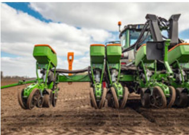
Großer Reihenabstand zum Anlegen einer Fahrgasse mit verschobenem Aggregat
