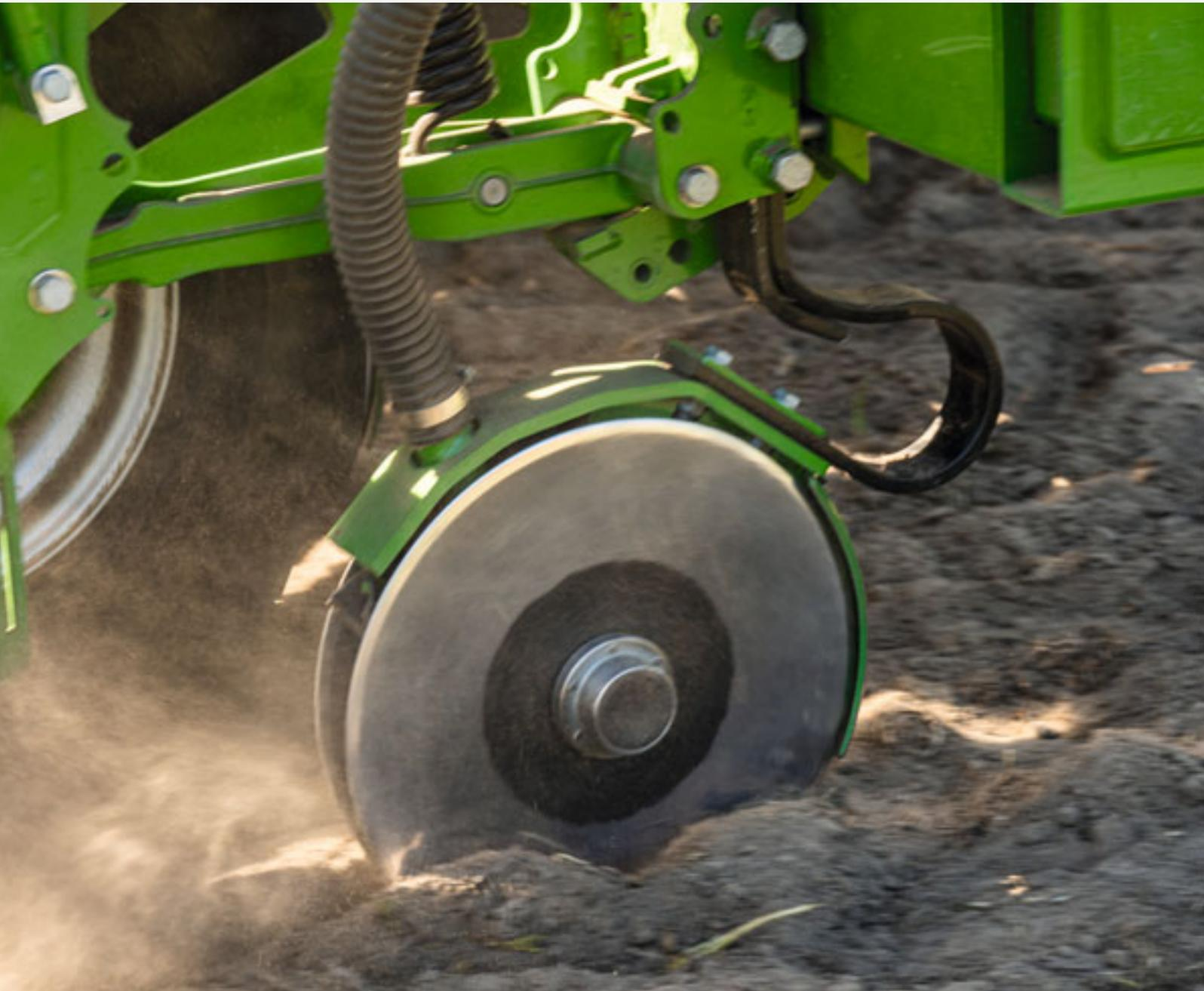
Das leistungsstarke FerTeC Twin-Doppelscheiben-Düngerschar eignet sich für die Pflug- und Mulchsaat
