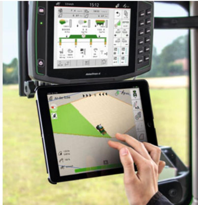
Jederzeit alles im Blick mit der AmaTron Twin App und dem Halter-Set für ein Tablet zur festen Montage am AmaTron 4
