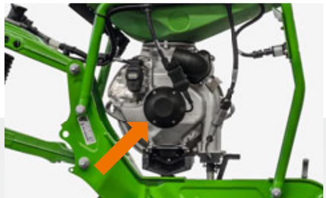
Mit elektrischem Antrieb ElectricDrive
