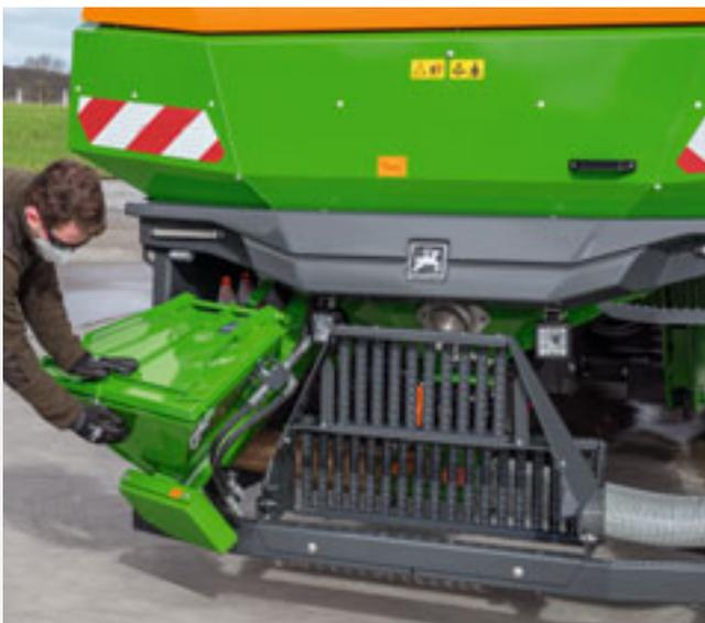
Bei einer Front-Heckkombination lässt sich der FTender, mit einem Behältervolumen von 1.600 oder 2.200 l, ebenfalls optional mit einer Befüllschnecke für Dünger befüllen.
