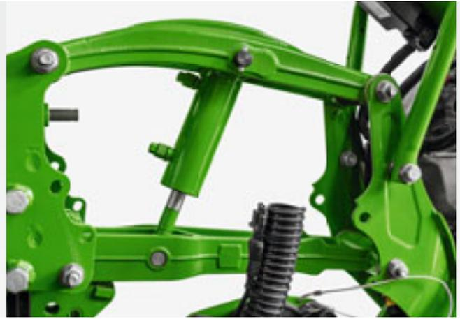
Über den Zylinder kann der Schardruck einfach hydraulisch eingestellt werden
