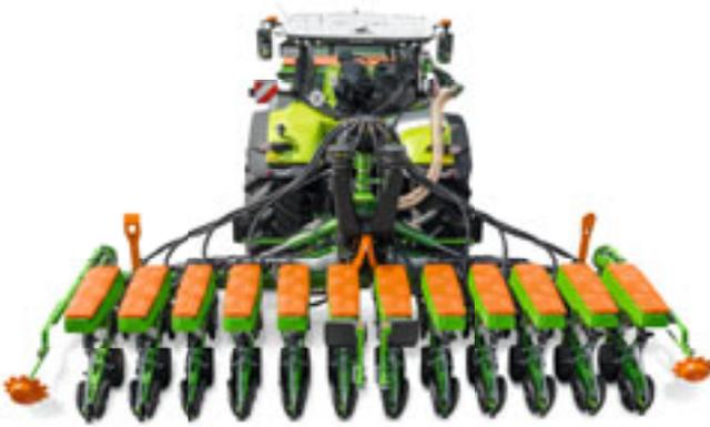
Precea 6000-2FCC mit 12 Reihen im ausgeklappten Zustand
