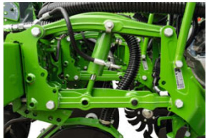
Über den Hydraulikzylinder wird der Schardruck automatisch eingestellt
