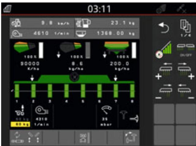
Übersichtliche Einbindung des Mikrogranulatstreuer in das Arbeitsmenü des Terminals
