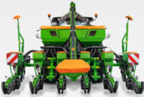
Die Precea 4500-2CC mit Teleskoprahmen bei voller Arbeitsbreite
