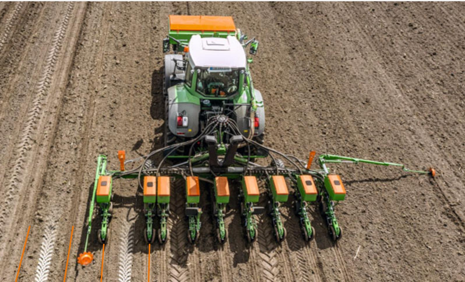
Die Precea 6000-2FCC mit hydraulischer Verschiebefahrgasse bietet optimales Ertragspotenzial
