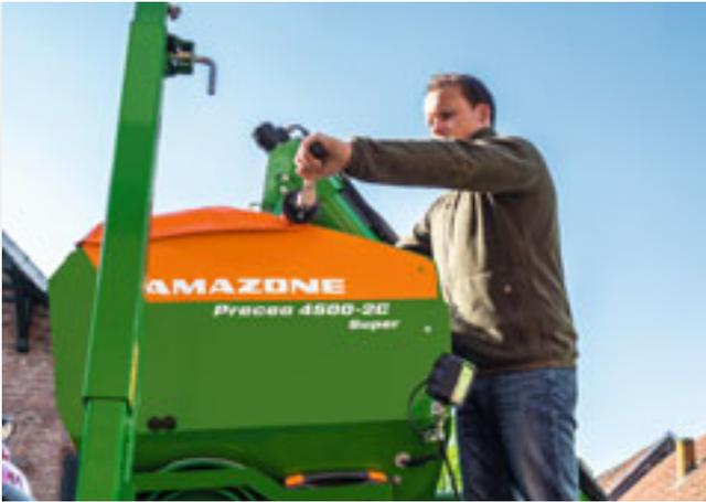
Die gute Zugänglichkeit des Düngerbehälters, die Abdeckrollplane und die große Befüllöffnung machen den Befüllvorgang komfortabel
