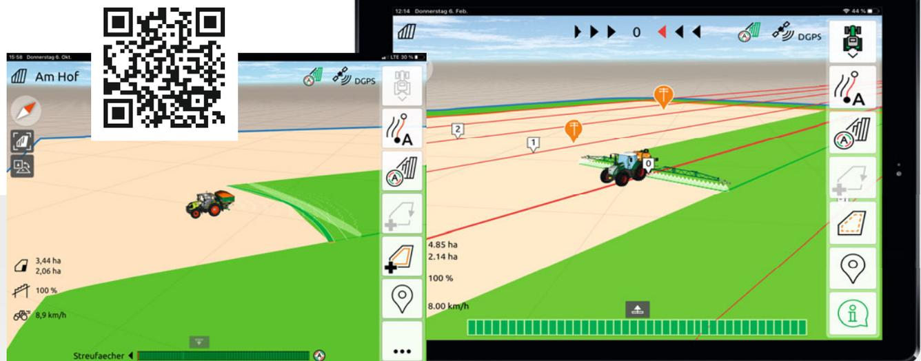
Alternative Kartenansichten mit AmaTron Twin – Übersichtliche Darstellung der Arbeitsmaschine und ihrer Teilbreiten sowie Schaltflächen auf der rechten Seite des mobilen Endgeräts.
