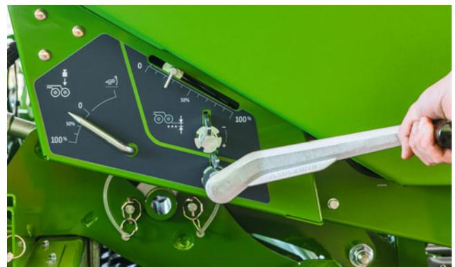
Zentrale stufenlose mechanische Schardruckverstellung mit Skala der Cataya Super
