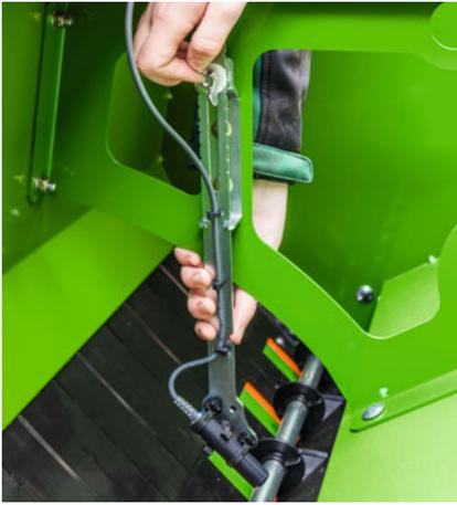
Einfachste Umstellung von Fein- auf Normalsaatgut mittels SchlieÙschieber
