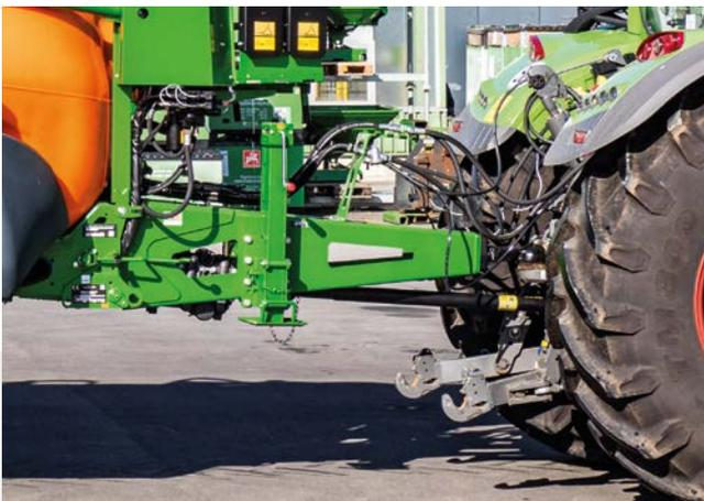
Obenanhängung mit Zugkugelpkupplung und mechanischem Stützfuß
