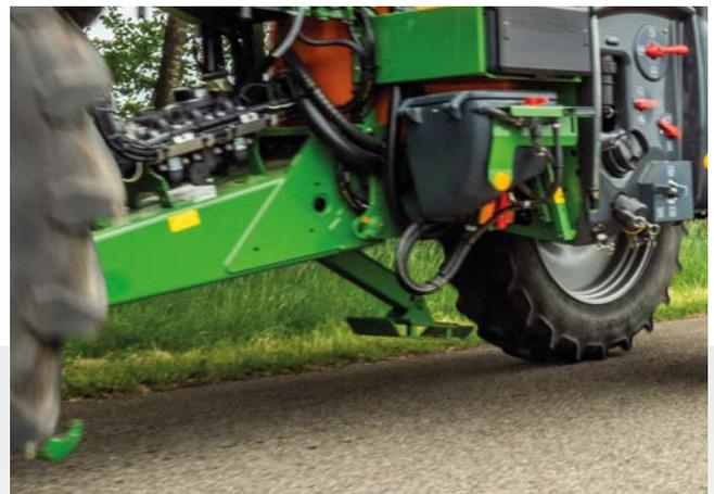
Untenanhängung mit hydraulischem Stützfuß
