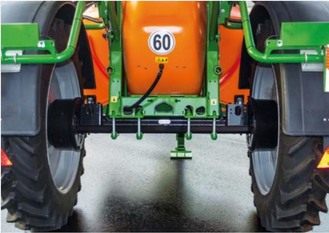
Festachse mit Spurweiten von 1,50 m bis 2,25 m
