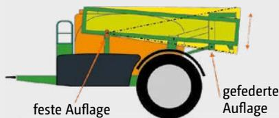
✔ Alles sitzt: Das Gestänge sitzt spielfrei gesichert in der Transportstellung. Stöße werden auf dem Feld und auch in der Transportstellung über die Parallelogrammaufhängung abgedefert. Das ist Komfort pur und sichert vor allem die Langlebigkeit des Gestänges.
