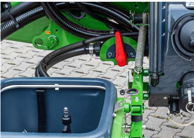
Die Injektorzuschaltung der UX Special ermöglicht Befüllleistungen bis 500 l/min.
