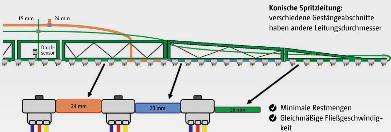
Hochdruck-Zirkulationssystem DUS pro mit konischer Spritzleitung am Beispiel AmaSwitch
