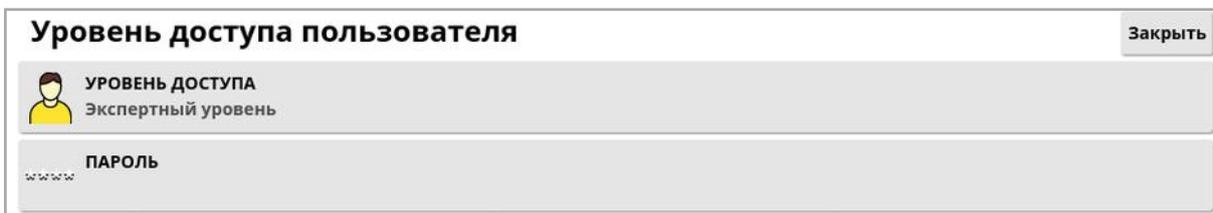
Уровень доступа может быть Простым, Стандартным или Экспертным. Для стандартного и экспертного уровней можно установить пароль, чтобы неопытные пользователи не могли получить доступ к этим уровням.
