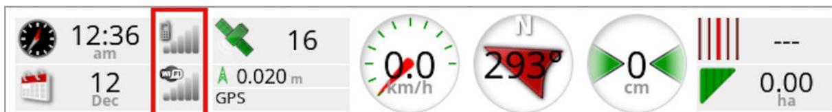
Панель силы сигнала показывает силу сигнала GPRS и радиосигнала.
