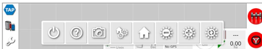
Для отображения панели инструментов дисплея необходимо коснуться нижней части экрана и провести пальцем по экрану снизу вверх.
