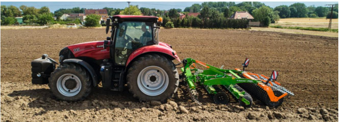
Große Erdkluten werden schon vor dem Scheibenfeld durch das Crushboard zerkleinert und sorgen für ein noch besseres Arbeitsergebnis
