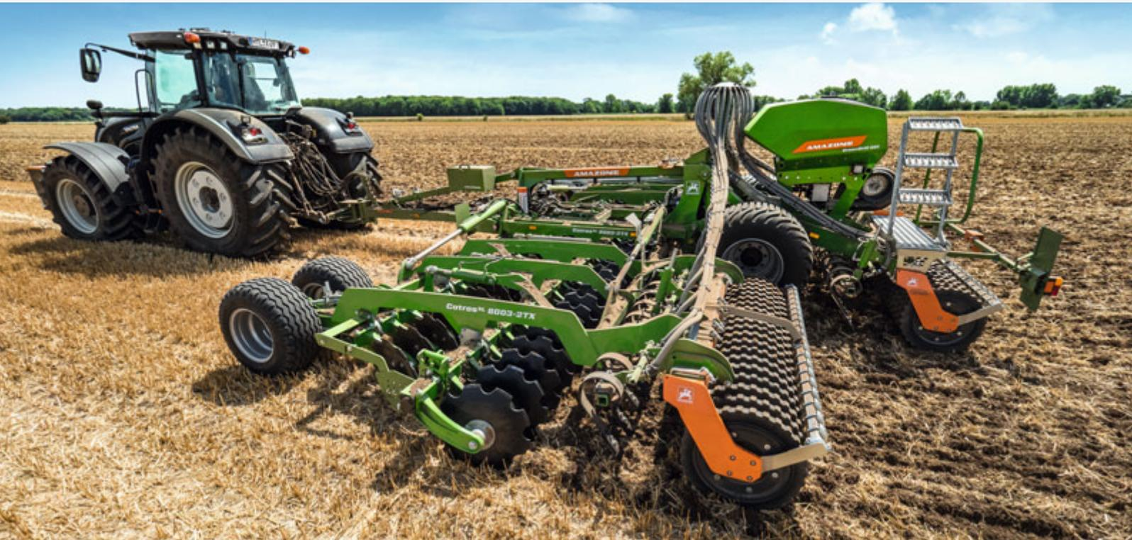
Catros<sup>XL</sup> 8003-2TX beim Stoppelsturz mit aufgebauter GreenDrill zur Zwischenfruchtsaat
