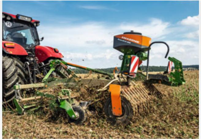
Catros<sup>XL</sup> 3003 mit X-Cutter-Disc, Messerwalze und GreenDrill
