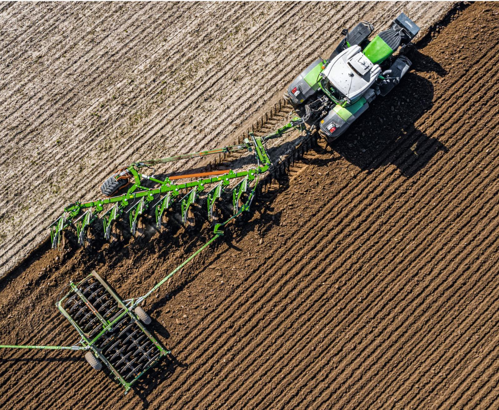
❗ „Mit zwei Spindeln für die Neigung, Clips für den Zylinder zur Tiefenbegrenzung am Stützrad und hydraulischer Vorderfurchen- sowie Schnittbreiten-Einstellung inklusive dauerhafter und gut lesbarer Skalen ist hier fast alles perfekt.“
