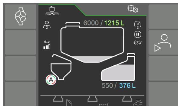
Sélectionner un réservoir pour ouvrir le sous-menu des fonctions du réservoir en question.
