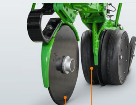
Двухдисковый сошник для внесения удобрений FerTeC twin
