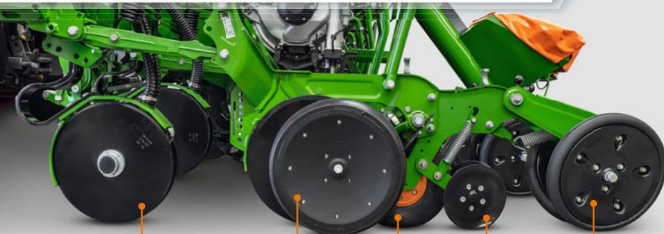
Двухдисковый сошник для внесения удобрений FerTeC twin
